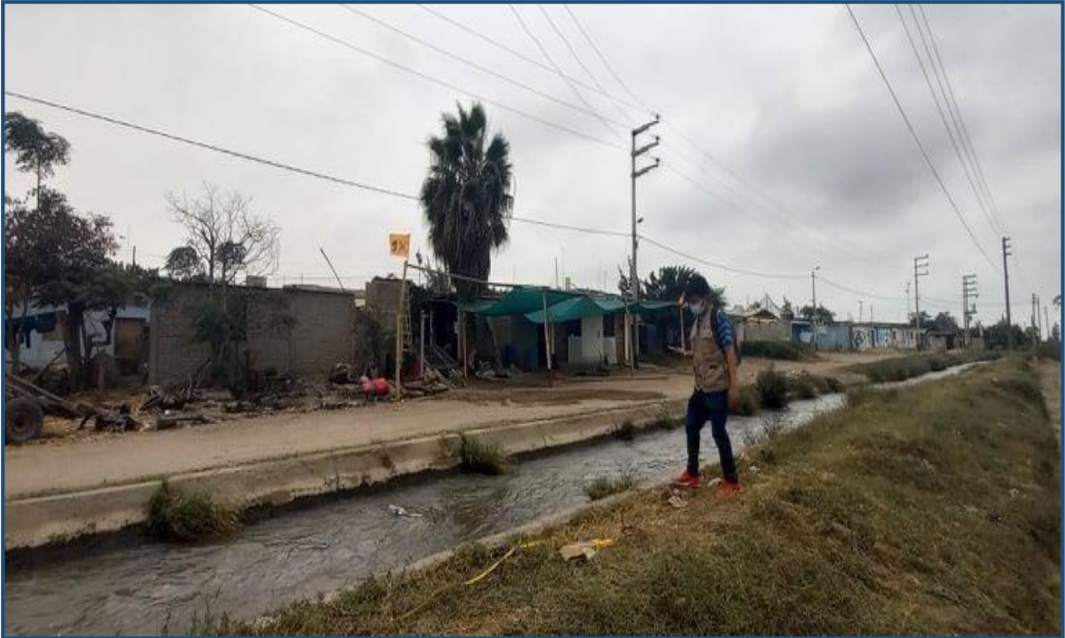
FIGURA N°. 34 CONTROL DE TIEMPO DEL CAUDAL DE AFORO
