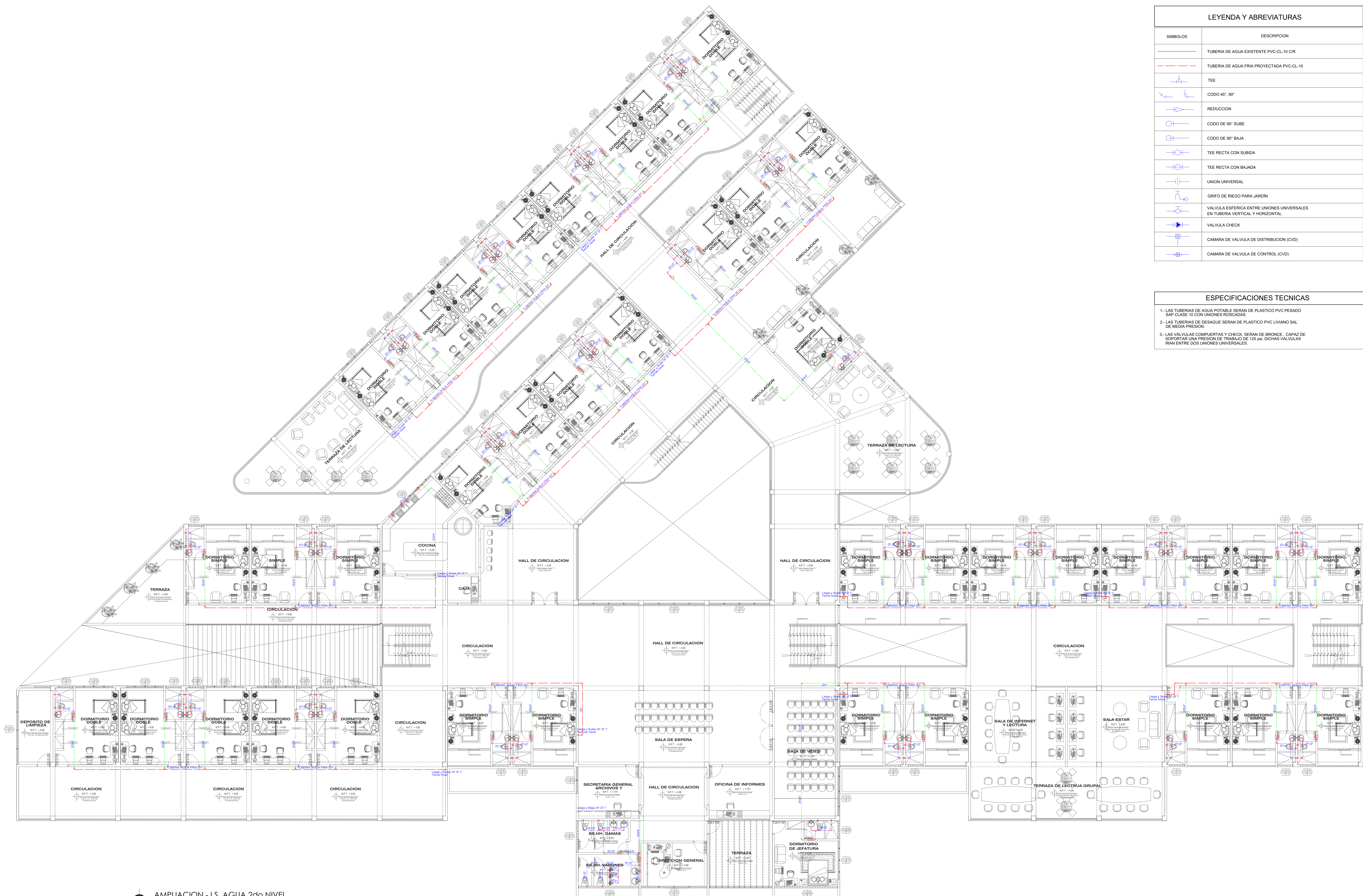
AMPLIACION - I.S. AGUA 2do NIVEL Escala 1:100
