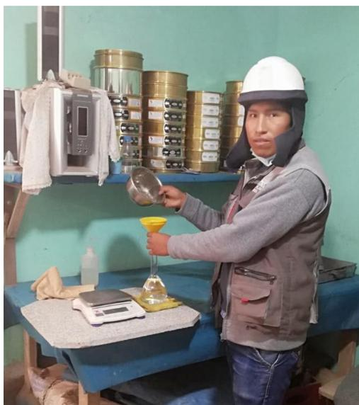
*Nota: en la figura 26 se observa el procedimiento con el equipo para la obtención del peso específico del agregado fino empleando la fiola el cual es llenado con el agregado fino.*
