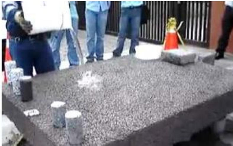
*nota: la figura 3 muestra un grupo demostrando el paso del agua a través de la losa de concreto permeable. Tomado de Rondan Darlin (2018)*
