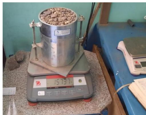
CARACTERIZACION DE MATERIALES (VIRUTA DE ACERO, AGREGADO GRUESO Y AGREGADO FINO)
