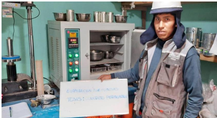
*Nota: en la figura 25 se muestra el colocado de las muestras al horno para su secado correspondiente*
