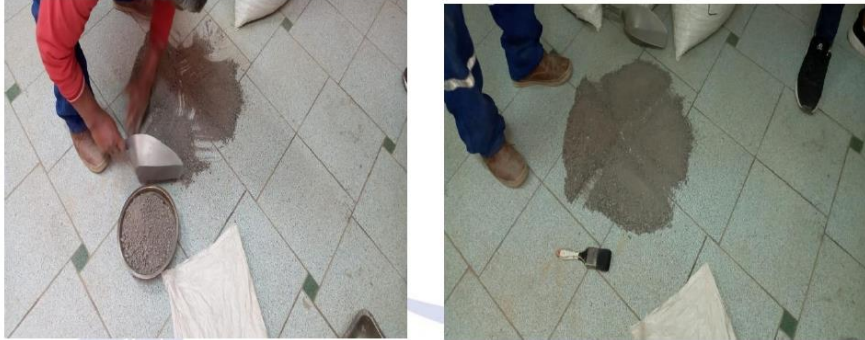
FOTOGRAFIA 1: MUESTRA 01 DE MATERIAL CONFITILLO DE LA CANTERA DE VICHO, SAN SALVADOR, LABORATORIO PARA REALIZAR SECADO AL HORNO Y PESAR MUESTRA.
