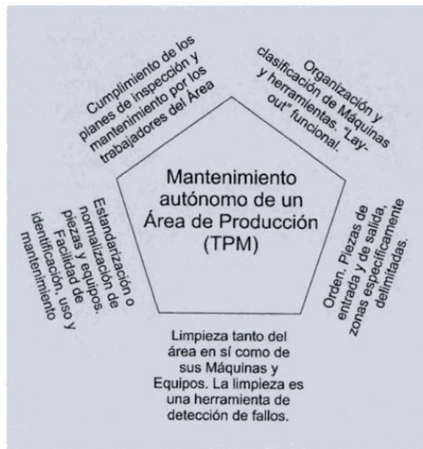
FIGURA 13: Mantenimiento autónomo de un área de producción
