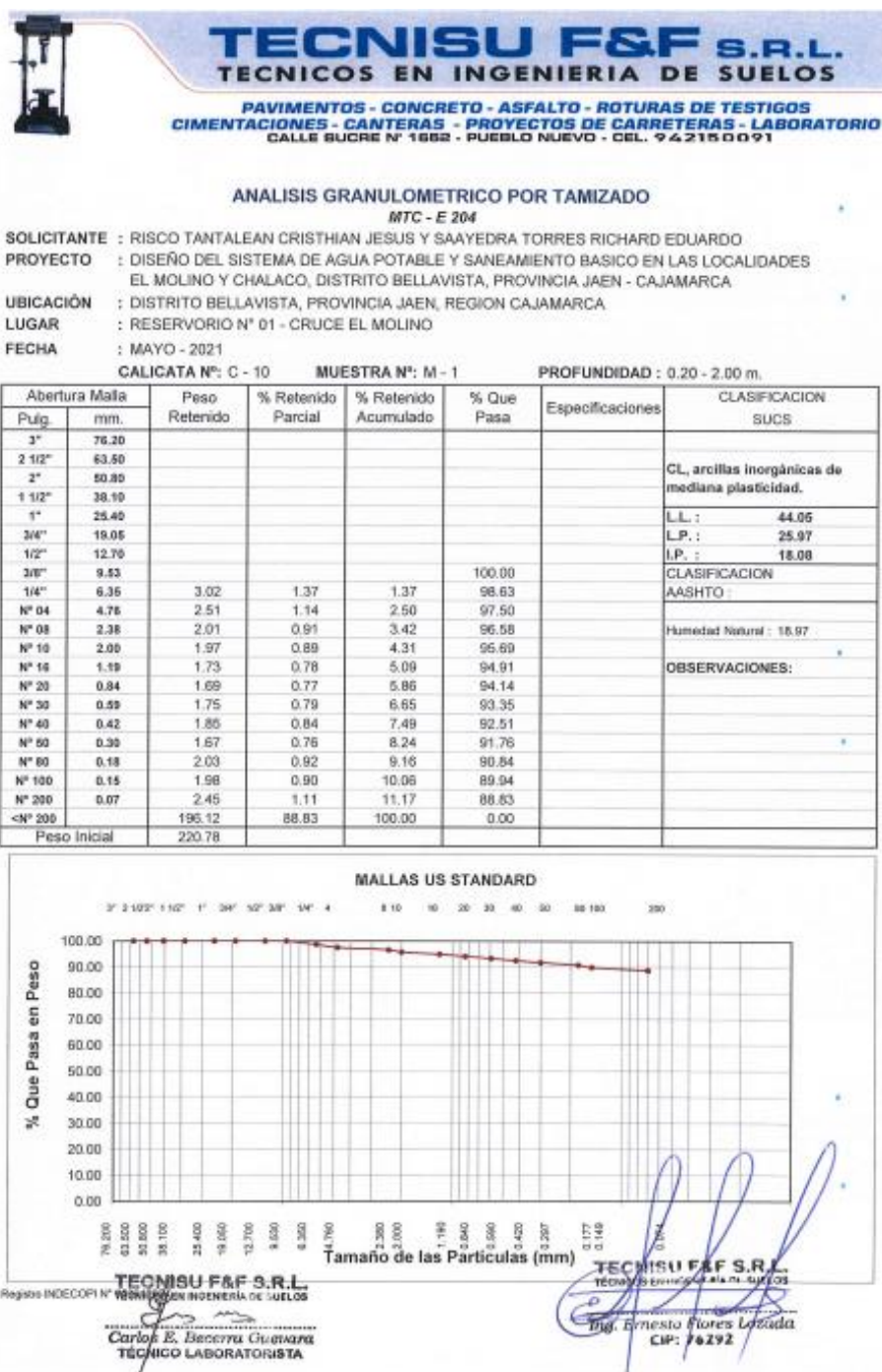
Figura 41. Cajamarca, Análisis granulométrico por tamizado C-10, 2021
