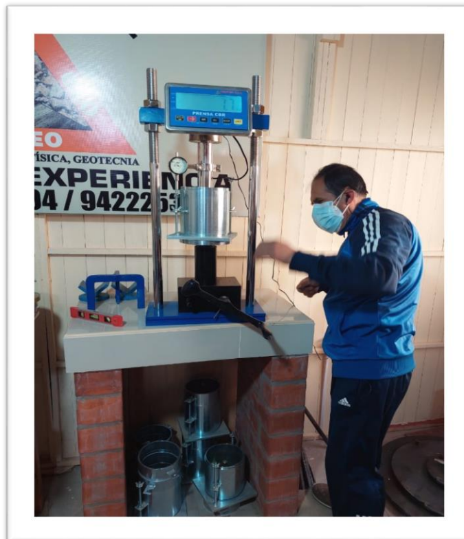
Fotografía N°16: Colocación del molde y muestra al equipo de CBR
