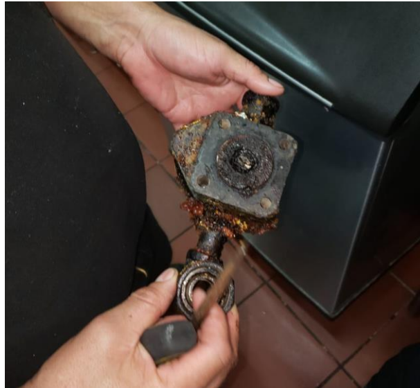
Figura 62. Bomba de filtrado deteriorada Fuente: Elaboración Propia
