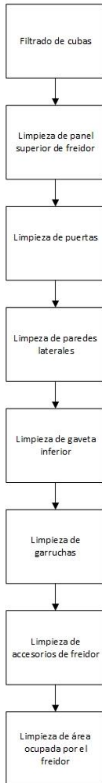
Figura 36. Proceso de Inspección y limpieza Fuente: Propia
