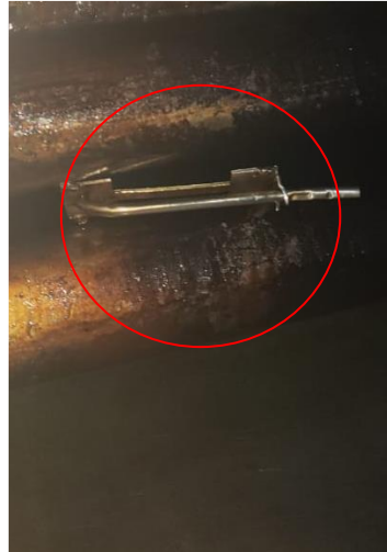
Figura 63. Sensor de temperatura golpeado Fuente: Propia
