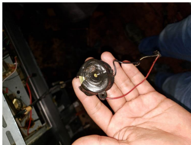
Figura 43. Bocina recalentada Fuente: Elaboración Propia
