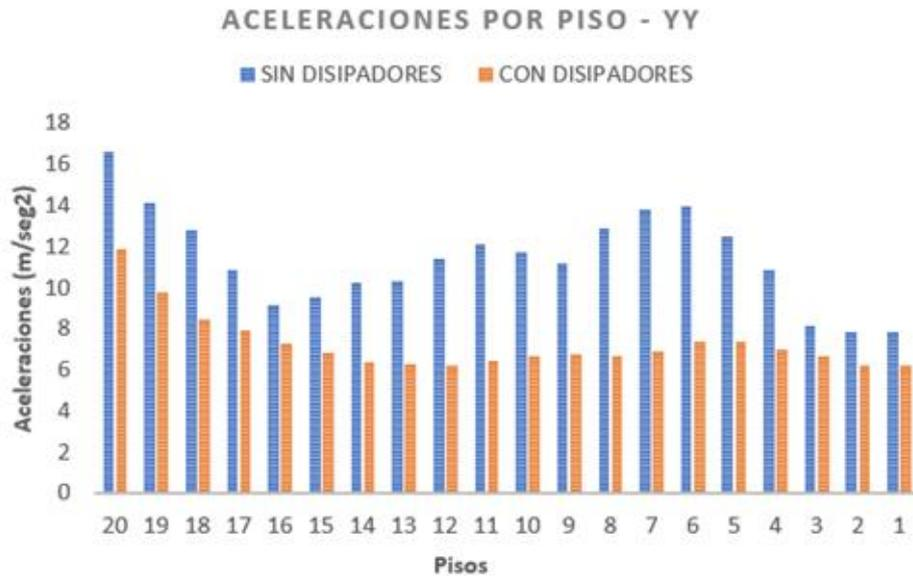
**Figura 28:** Aceleraciones por piso con y sin disipadores en "Y".
