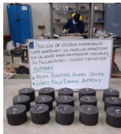
Figura 14: Briquetas de ensayo
