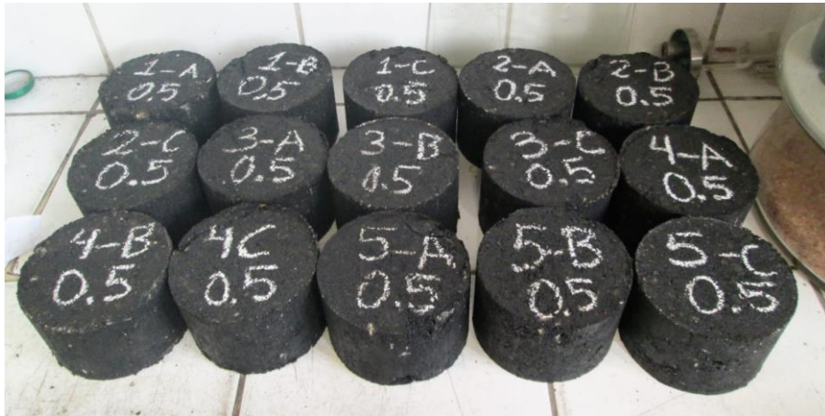
Fotografía 4: Ensayo de Marshall
