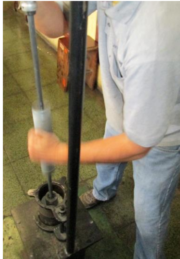
Fotografía 4: Ensayo de Marshall
