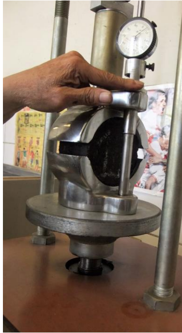
Fotografía 5: Ensayo de la mezcla de pavimento asfáltico
