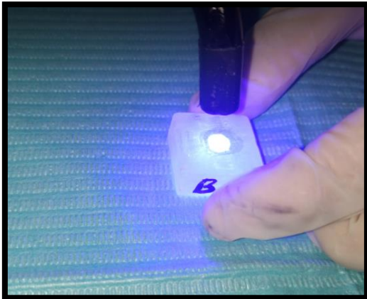
Figura n°29: Grupo B: Fotocurado al adhesivo por 10 segundos
