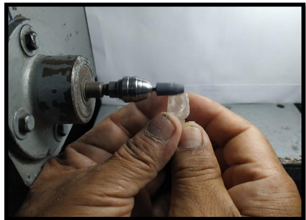
Figura n°7: Pulido de los bloques de acrílico
