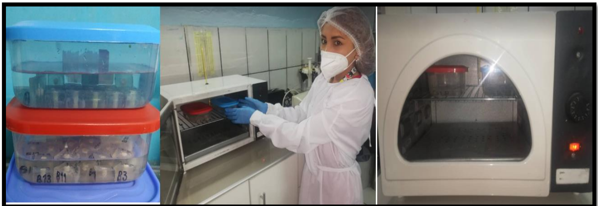
Figura n°16: Proceso de envejecimiento artificial en incubadora a 37°C por 28 días.
