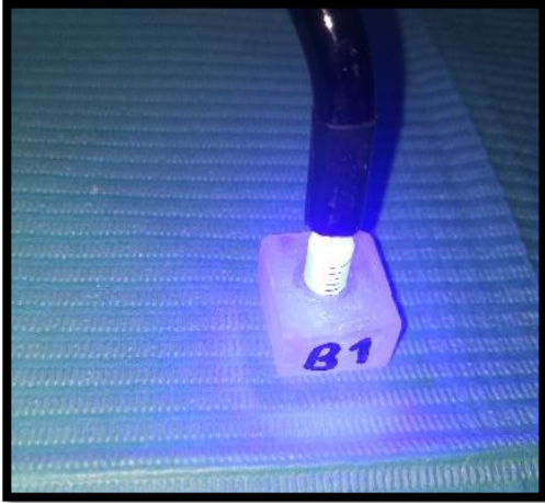
Figura n°33: Fotocurado por 20 segundos por capa de 4mm de resina Bulk-fill.
