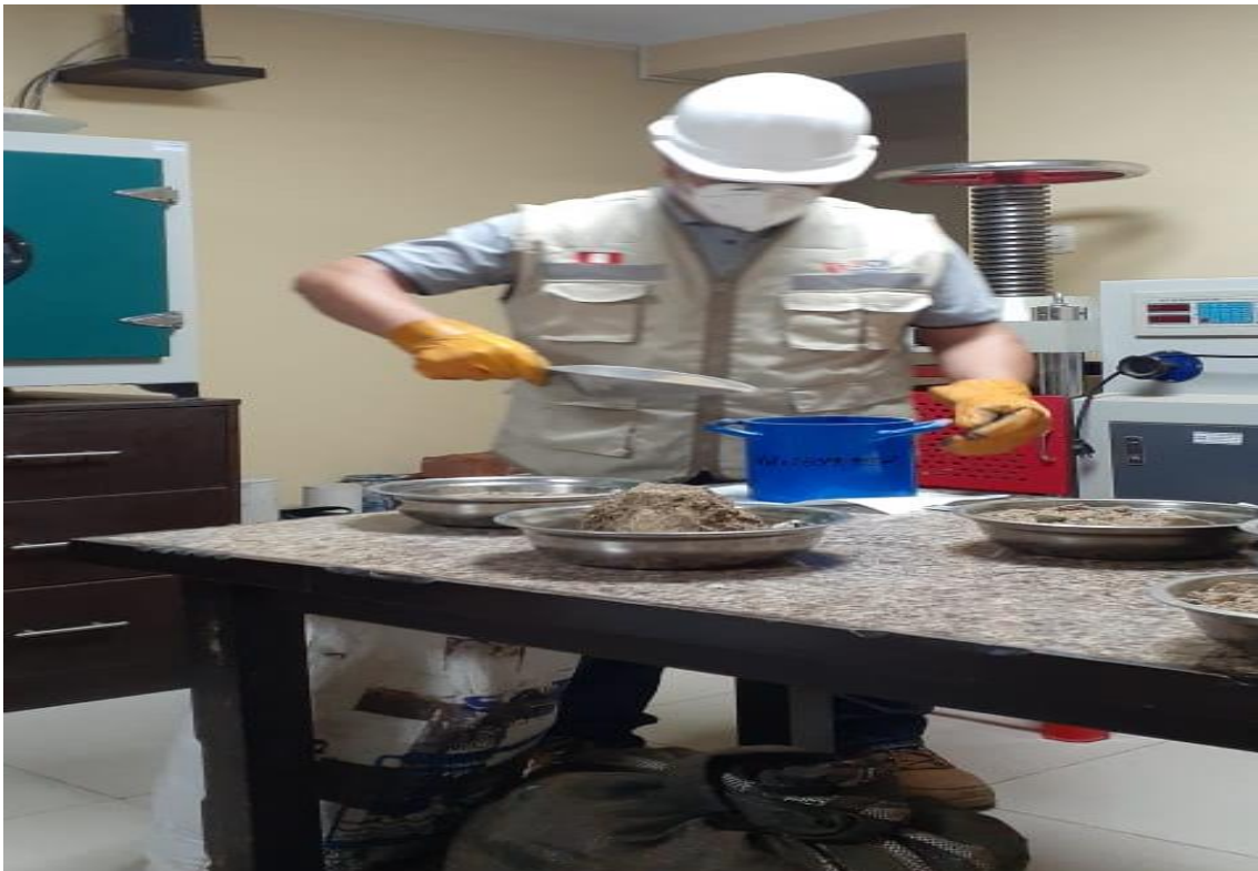
Llenado el agregado para el peso unitario suelto.
