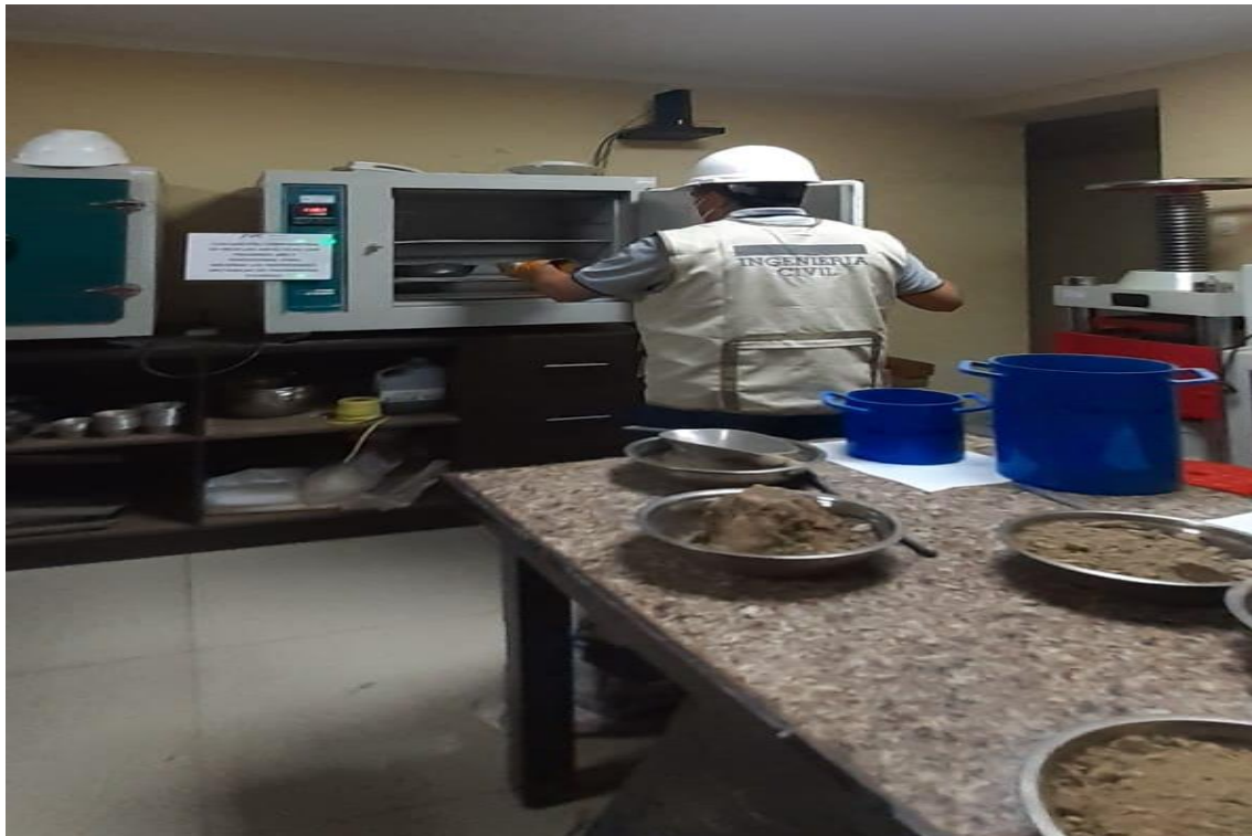
Secado de los agregados en el horno.
