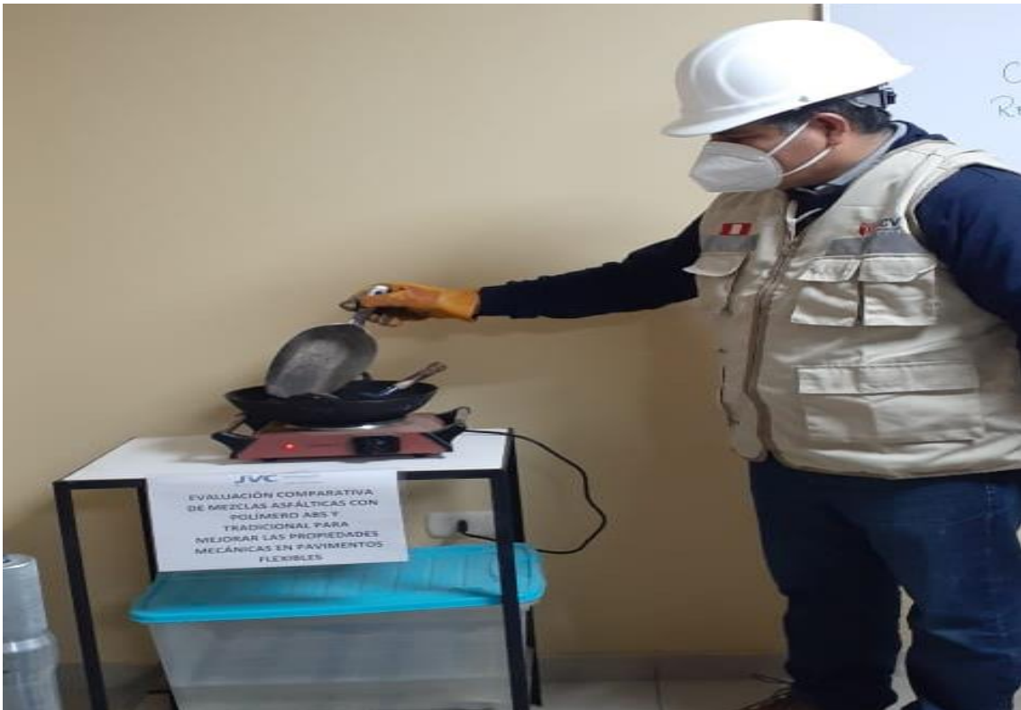
Calentamiento del asfalto.
