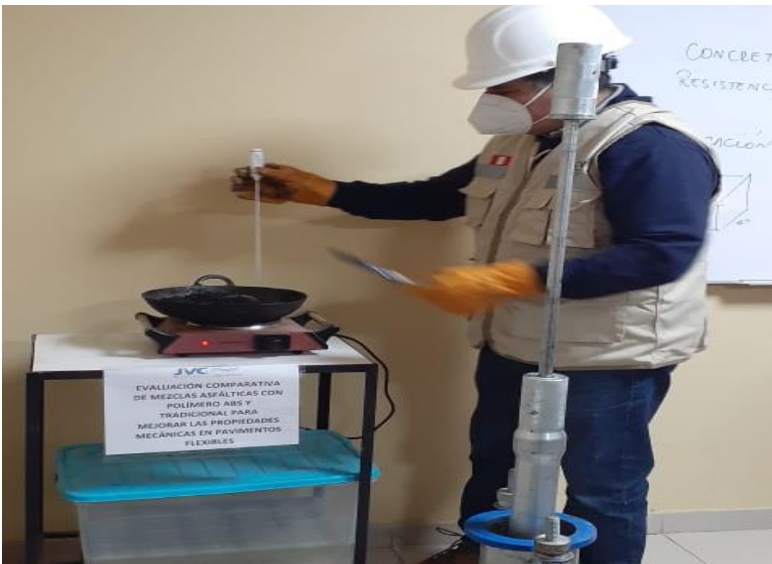
Midiendo la temperatura del asfalto.
