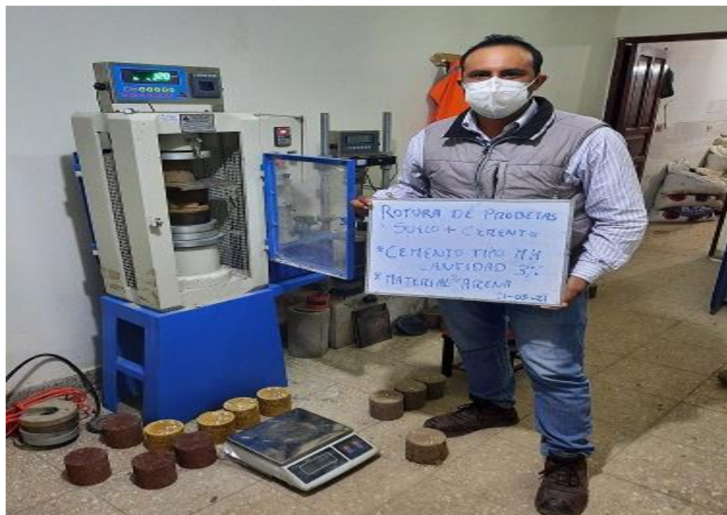
Fotografía 14: Rotura probeta suelo-cemento
