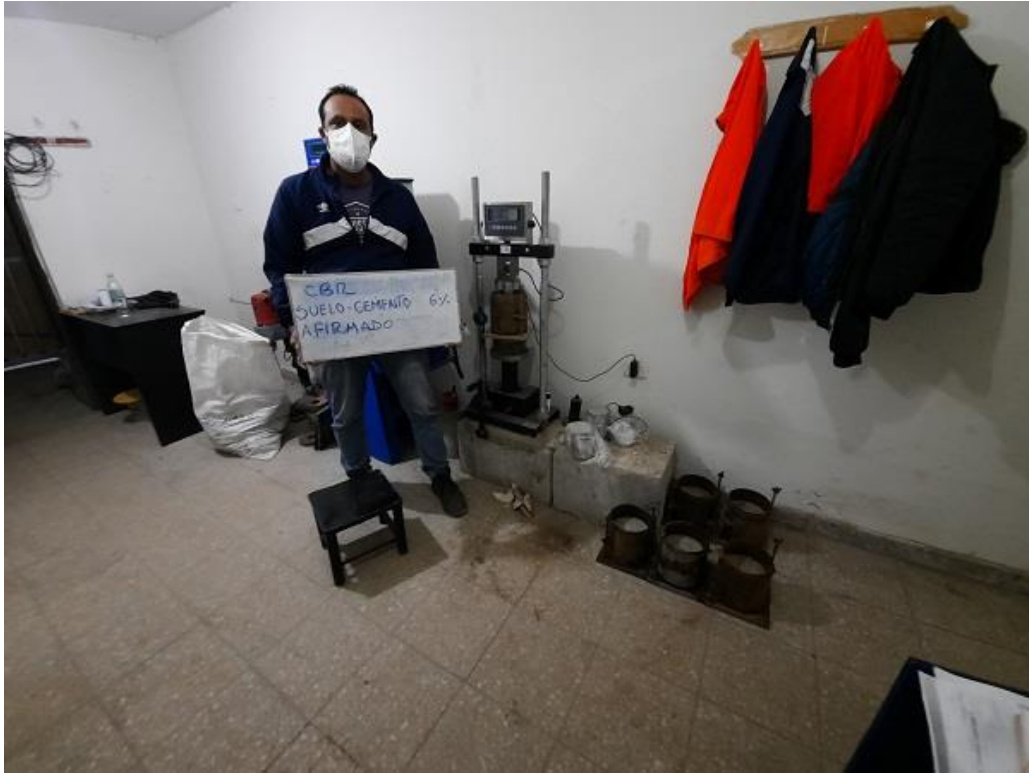
Fotografía 21: Ensayo de CBR de suelo-cemento 6%
