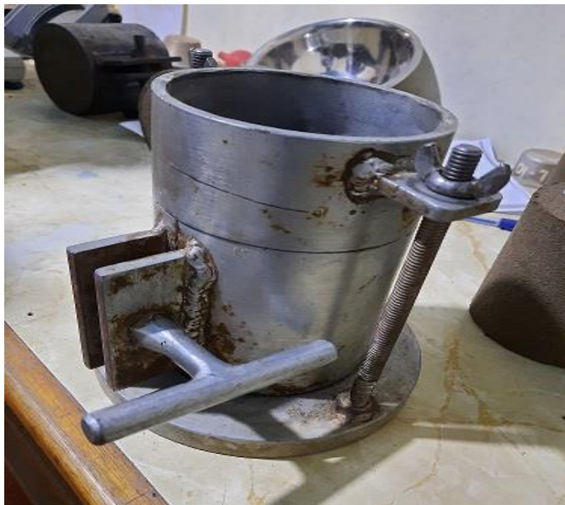
Fotografía 10: Molde para probeta suelo cemento
