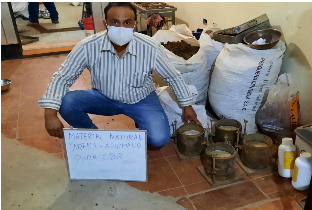
Fotografía 06: Moldes de material natural de arena y afirmado para CBR
