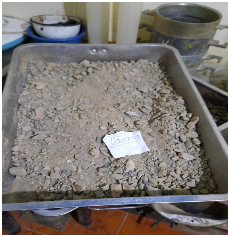
Fotografía 01: Muestra de afirmado para análisis granulométrico
