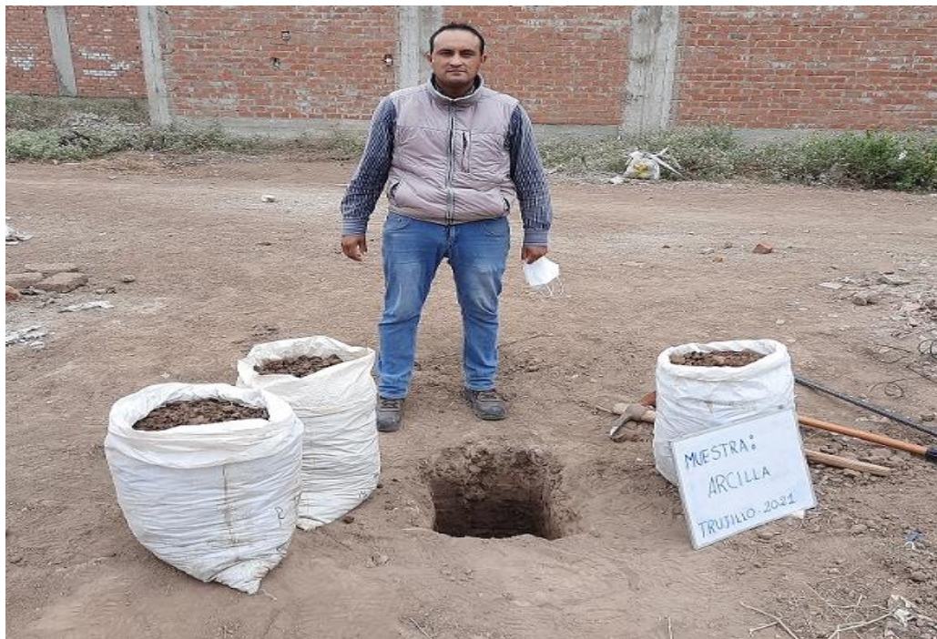
Fotografía 22: Calicata muestra de arcilla
