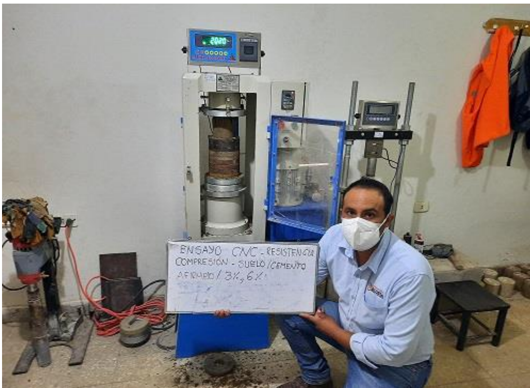
Fotografía 16: Rotura probeta suelo-cemento
