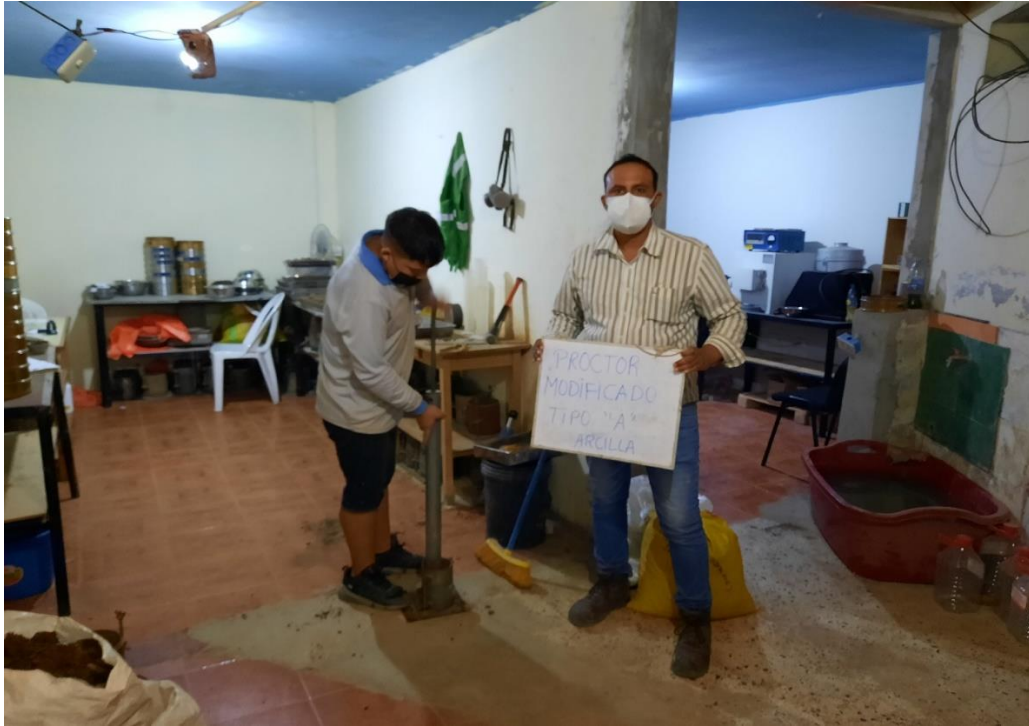
Fotografía 05: Ensayo Próctor modificado
