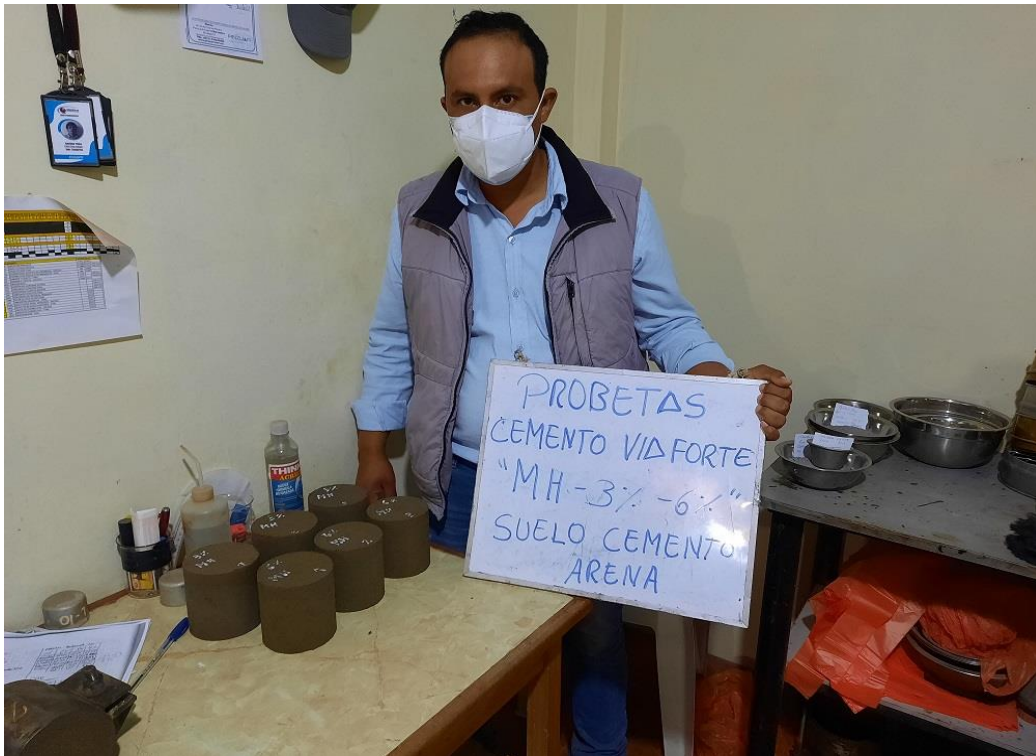
Fotografía 11: Probetas suelo- cemento
