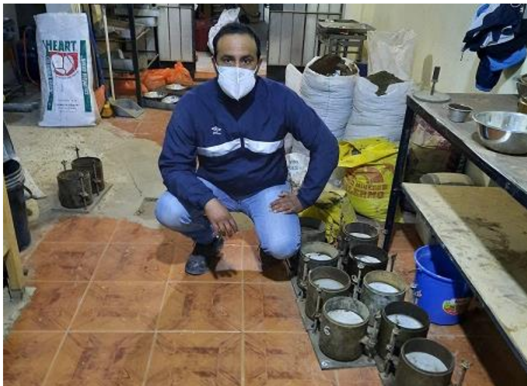
Fotografía 18: Moldes para CBR suelo-cemento 6%
