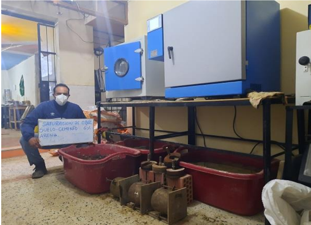
Fotografía 19: Saturación de moldes en agua para CBR suelo-cemento
