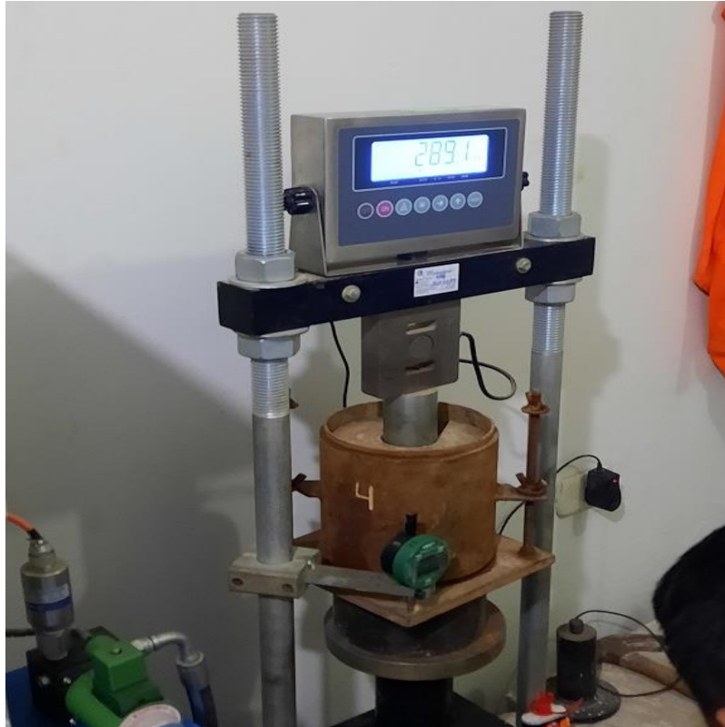
Fotografía 09: Ensayo de penetración (CBR) para suelo natural
