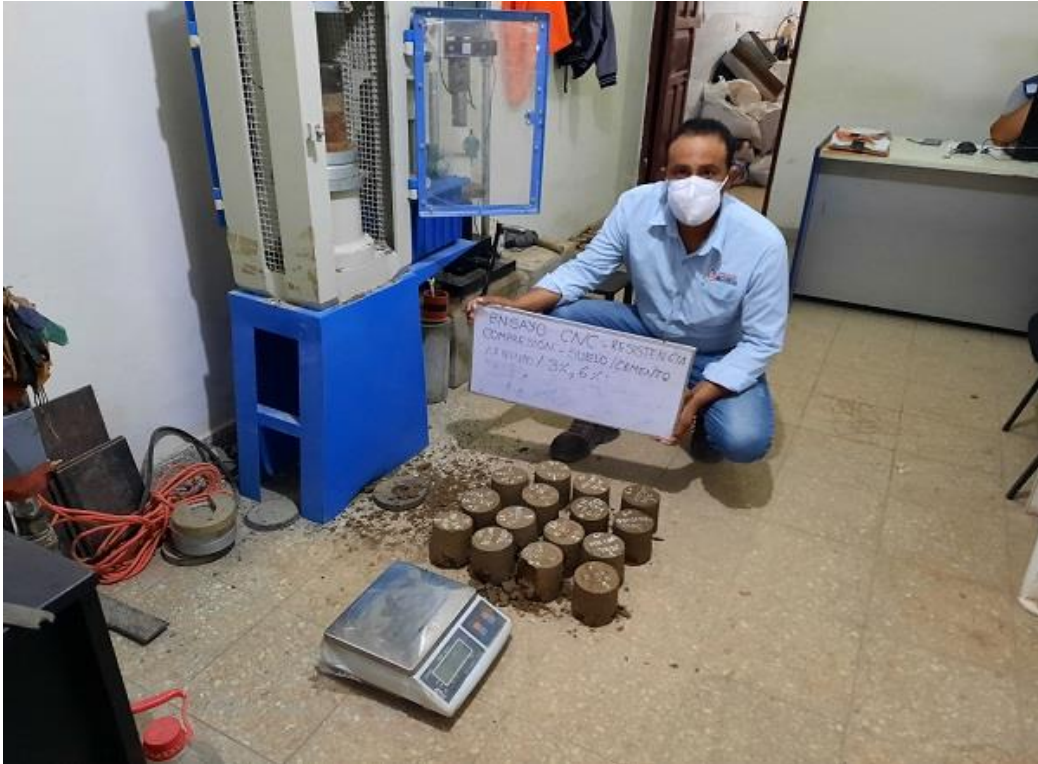
Fotografía 17: Rotura probeta suelo-cemento
