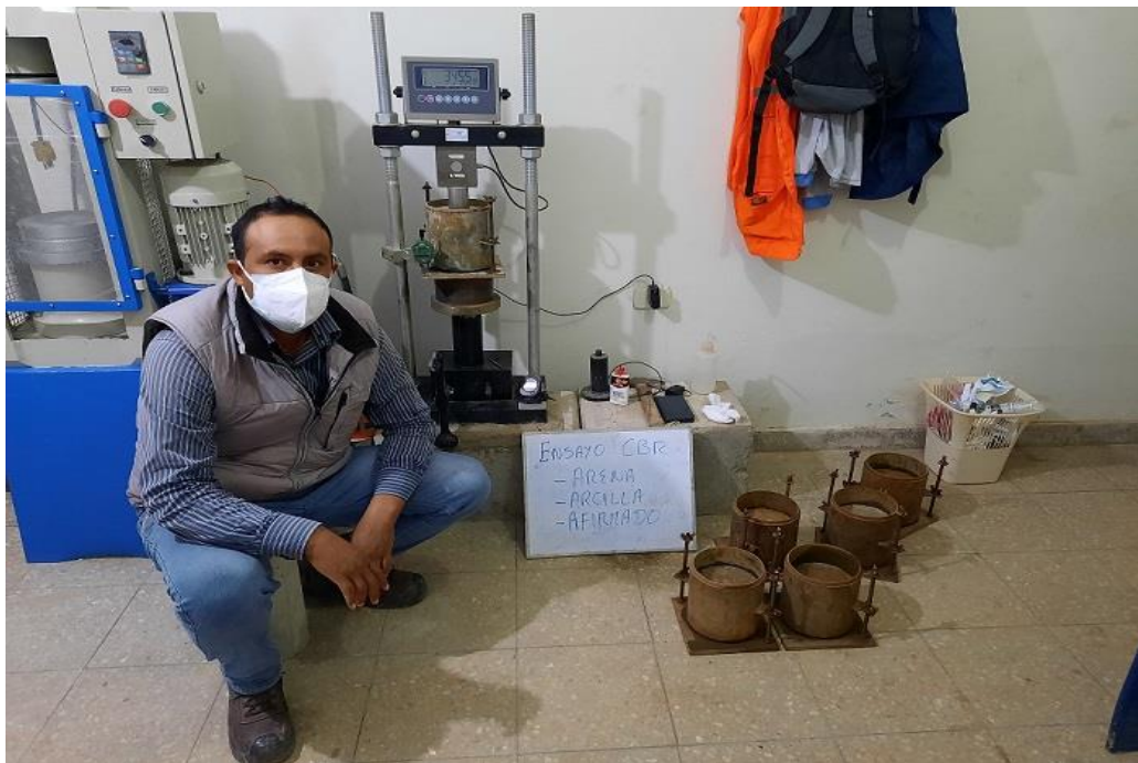
Fotografía 08: Ensayo CBR - suelo natural arcilla, arena y afirmado
