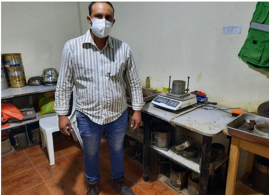
Fotografía 04: Muestra arena en balanza para Próctor modificado
