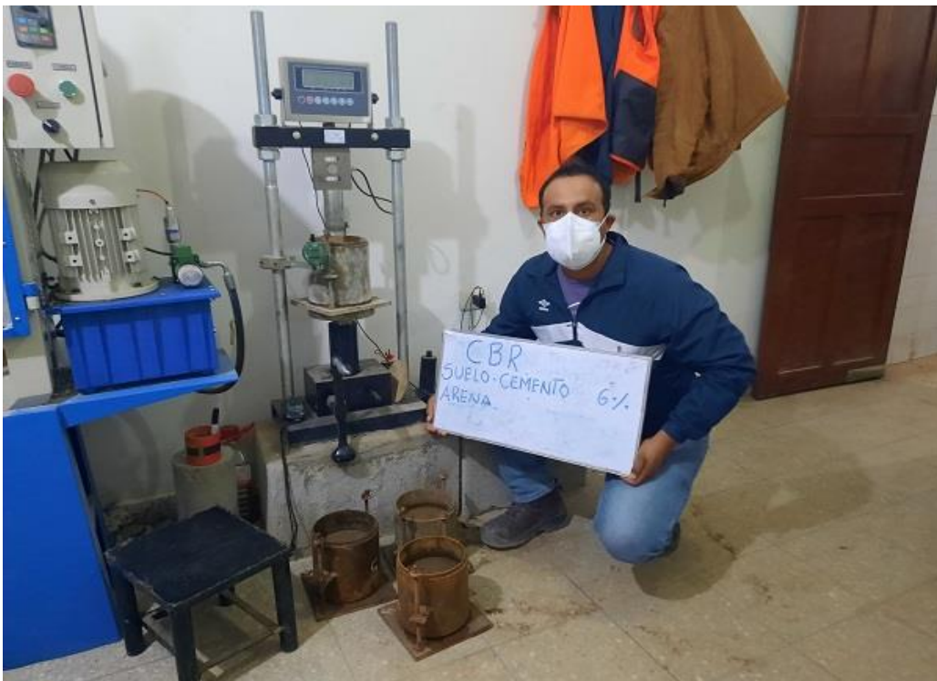
Fotografía 20: Ensayo de CBR de suelo-cemento 6%
