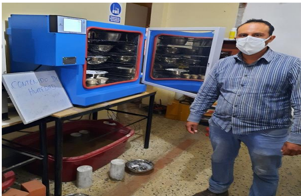
Fotografía 02: Muestras en horno para contenido de humedad
