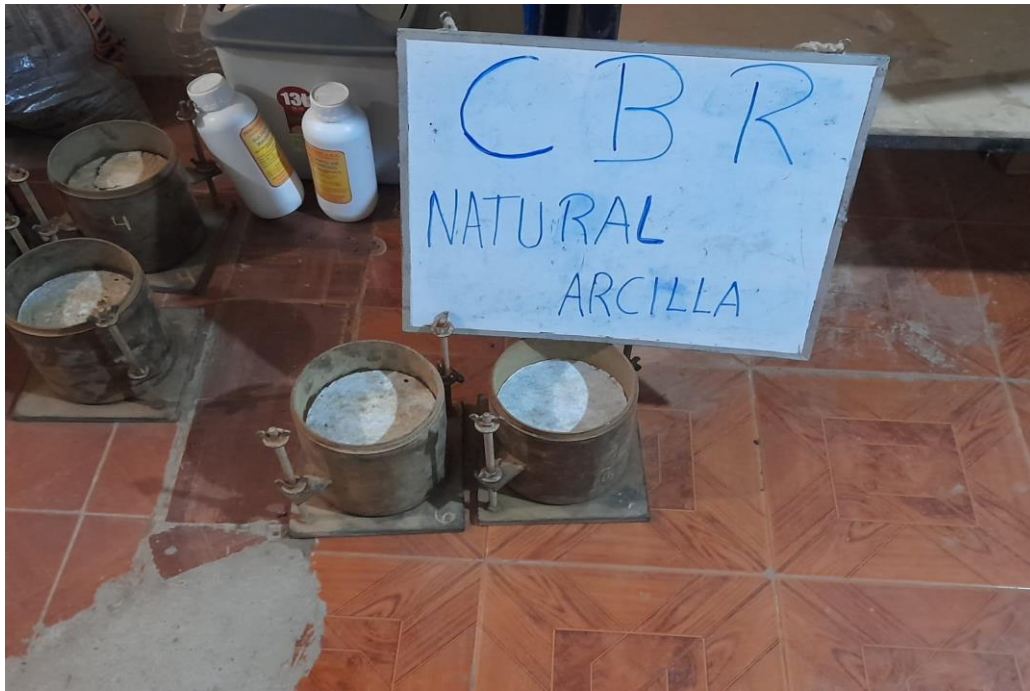
Fotografía 07: Moldes de material natural arcilla para CBR
