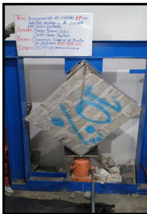
Figura N° 39. Ruptura del murete con 10% de PP.
