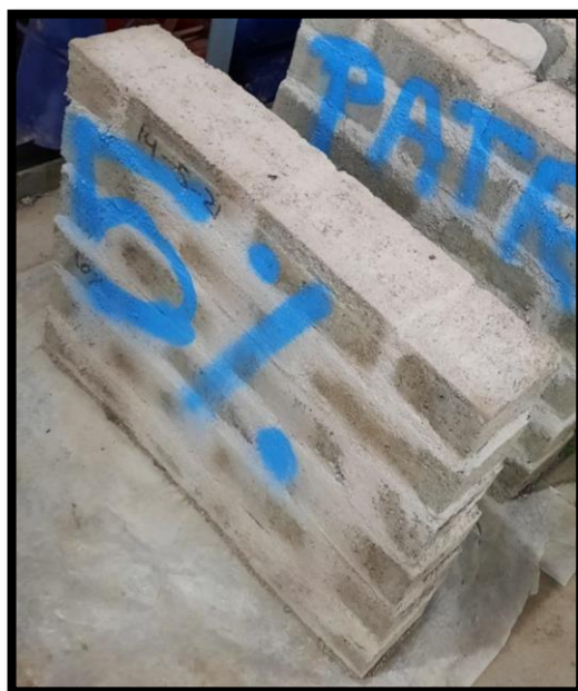
Figura N° 36. Ensayo de muretes con 5% de PP.
