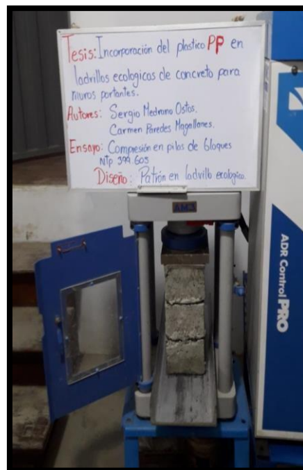
Figura N° 25. Ruptura de las Pilas del patrón.
