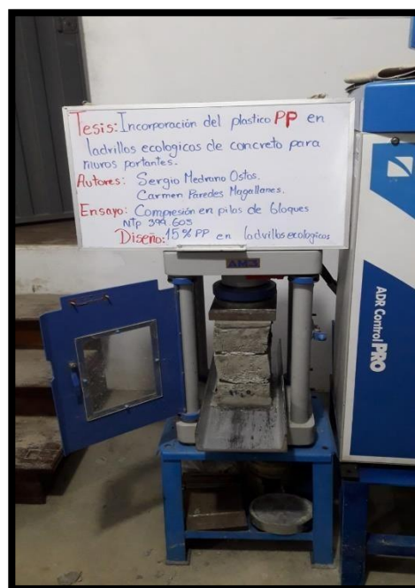
Figura N° 31. Ruptura de las Pilas con 15% de PP.
