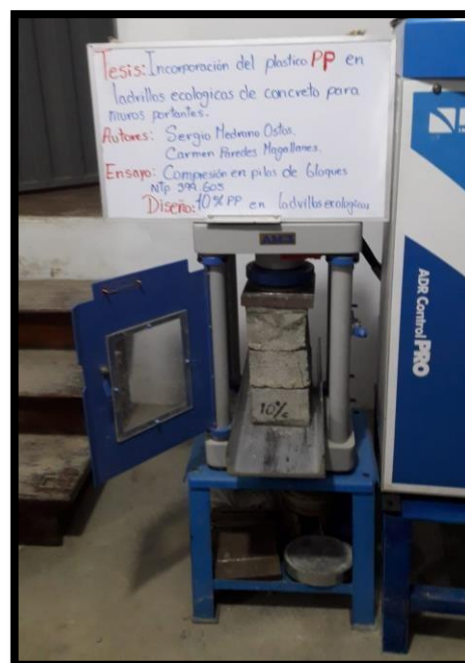
Figura N° 29. Ruptura de las Pilas con 10% de PP.
