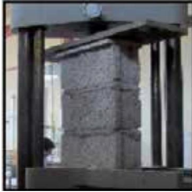
Figura N° 5. Ensayo de resistencia a la compresión en Pilas.
