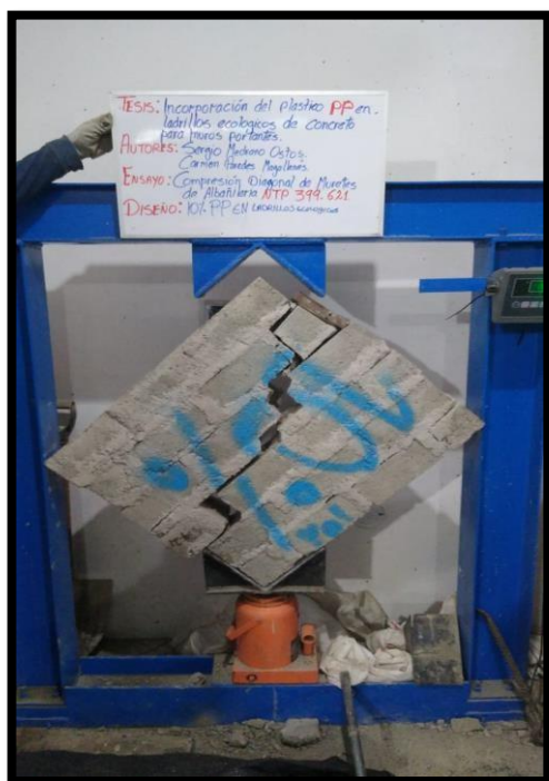
Figura N° 38. Ensayo de muretes con 10% de PP.
