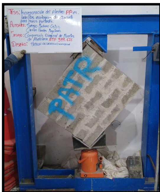
Figura N° 34. Ensayo de la compresión diagonal de muretes patrón.
