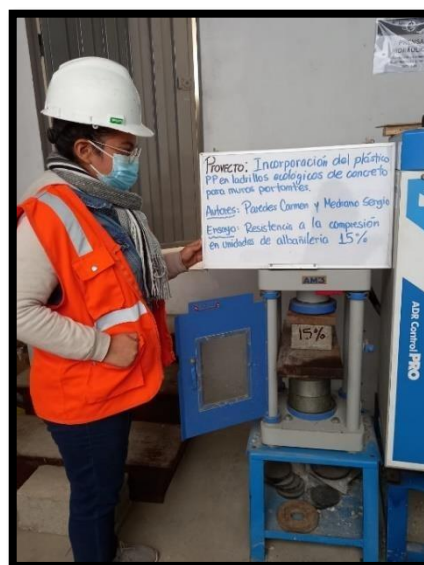
Figura N° 21. Ensayo de Resistencia a la Compresión Fuente: Elaboración propia
