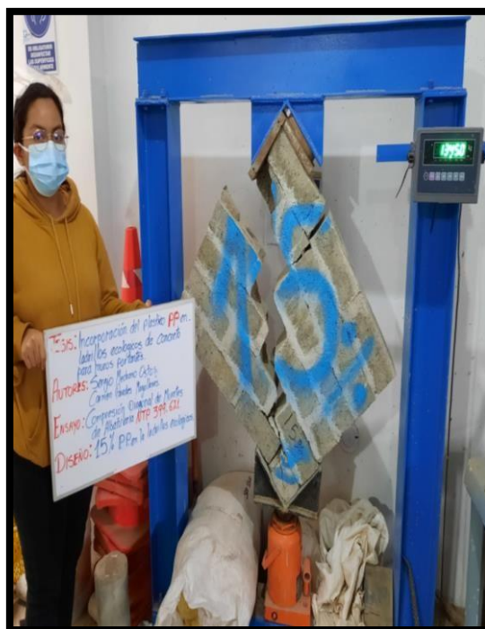
Figura N° 41. Ruptura del murete con 10% de PP. Fuente: Elaboración propia
