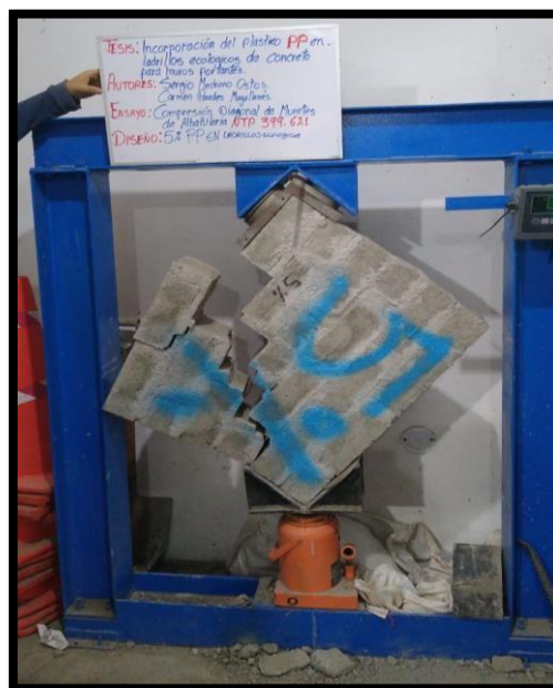
Figura N° 37. Ruptura del murete con 5% de PP.
