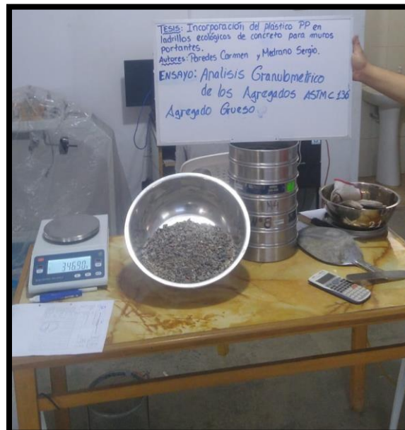
Figura Nº 12. Análisis granulométrico ASTM C 136
