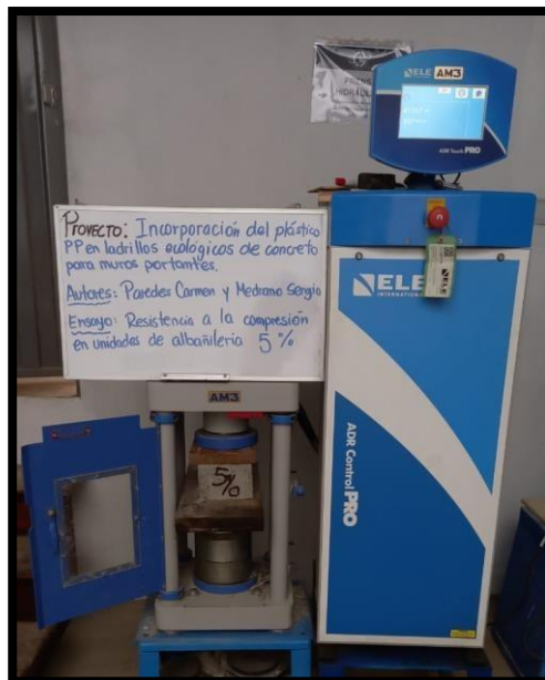
Figura N° 17. Ensayo de Resistencia a la Compresión del 5% de PP
