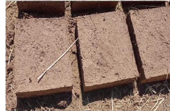
7. El terreno para el desmolde debe ser plano y seco. Debe rociarse previamente con una capa de arena.
