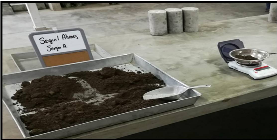
Realización del pesaje de la muestra. (ensayo Proctor Modificado)
