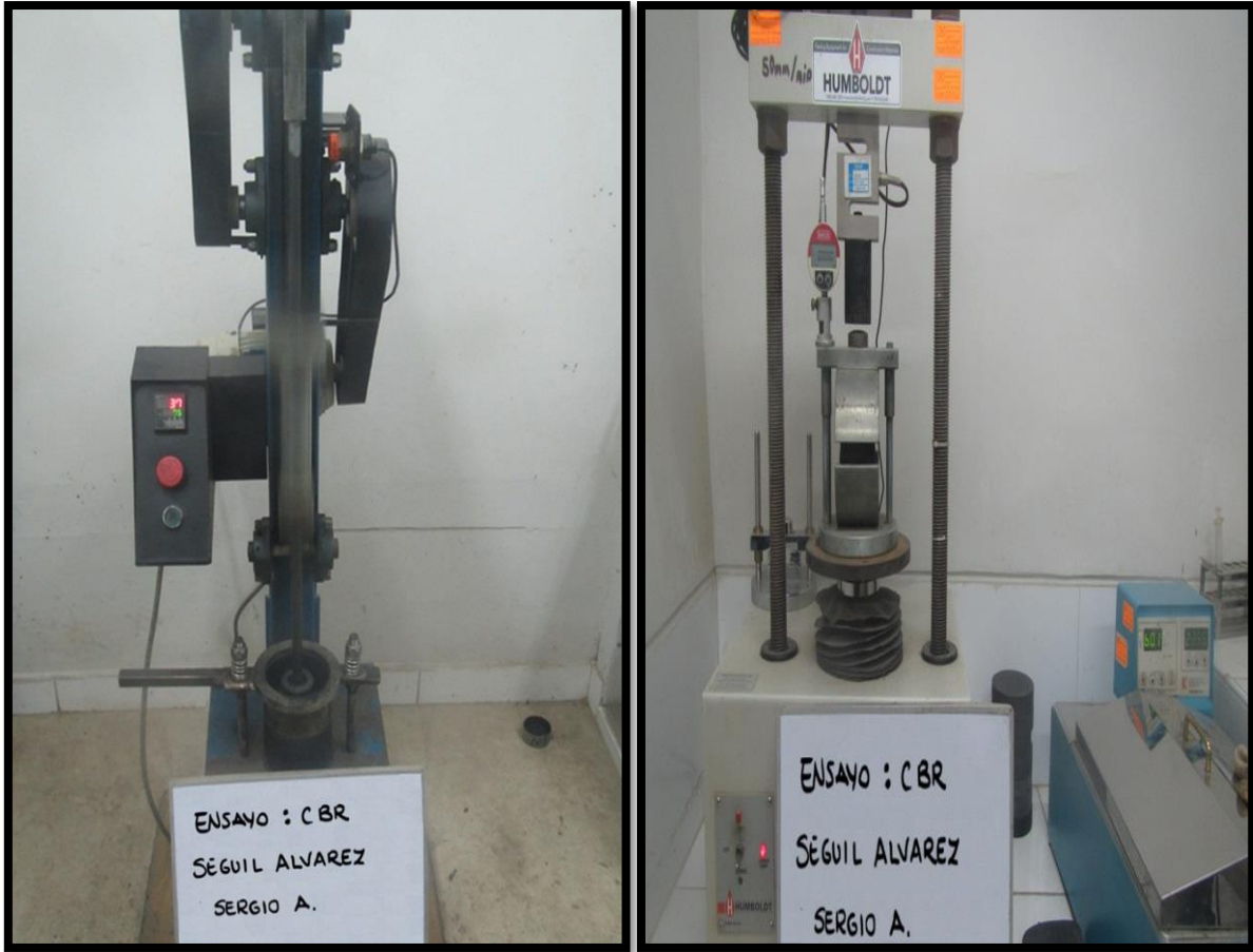
Se realizo las pruebas de laboratorio, ensayo de CBR en las muestras.
