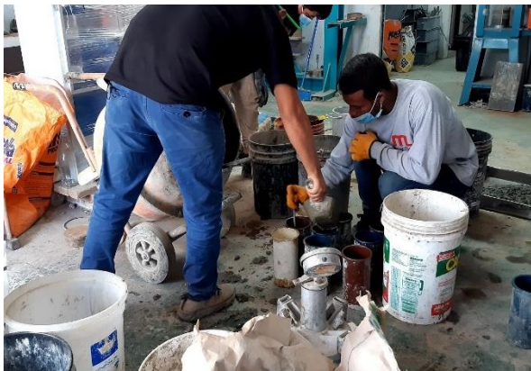
Fotografía 8. Vaciado de probetas
