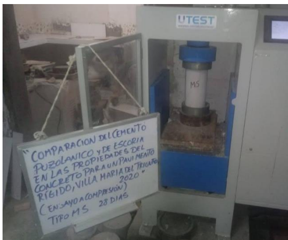
Fotografía 16. Ensayo de resistencia a la compresión del concreto MS
