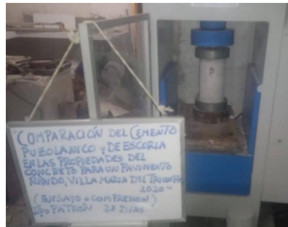
Fotografía 15. Ensayo de resistencia a la compresión del concreto patrón
