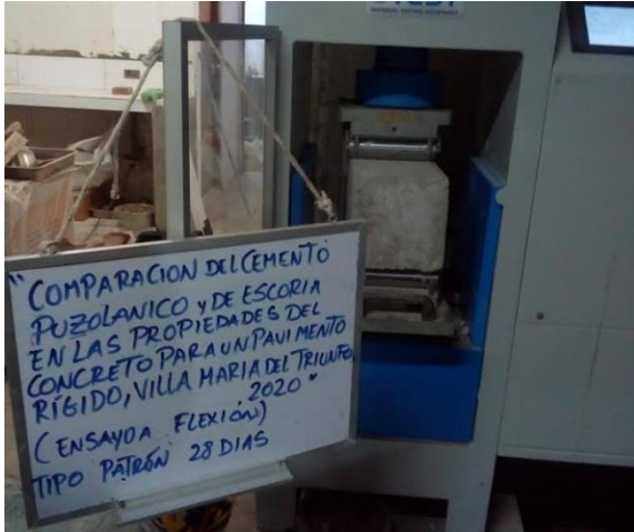
Fotografía 12. Ensayo de resistencia a la flexión del concreto tipo I
