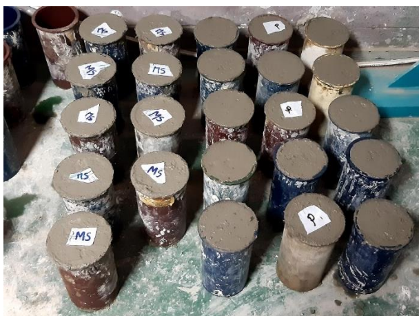
Fotografía 10. Probetas cilíndricas 6''x12''
