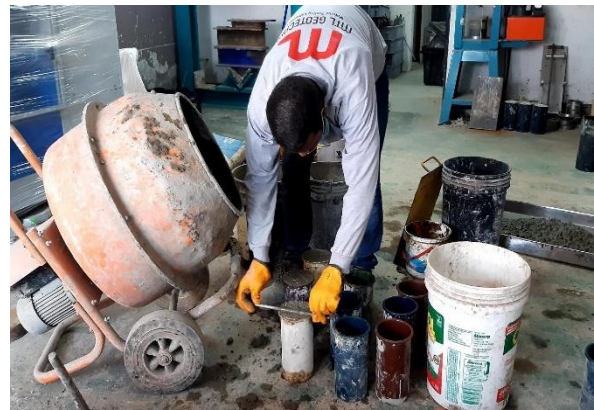
Fotografía 9. Nivelación con varilla del exceso de mezcla
