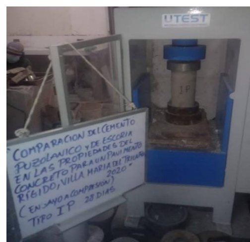
Fotografía 17. Ensayo de resistencia a la compresión del concreto IP
