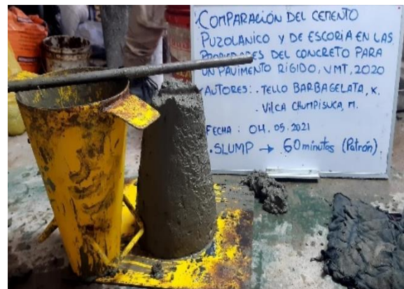
Fotografía 7. Ensayo del SLUMP del cemento Patrón
