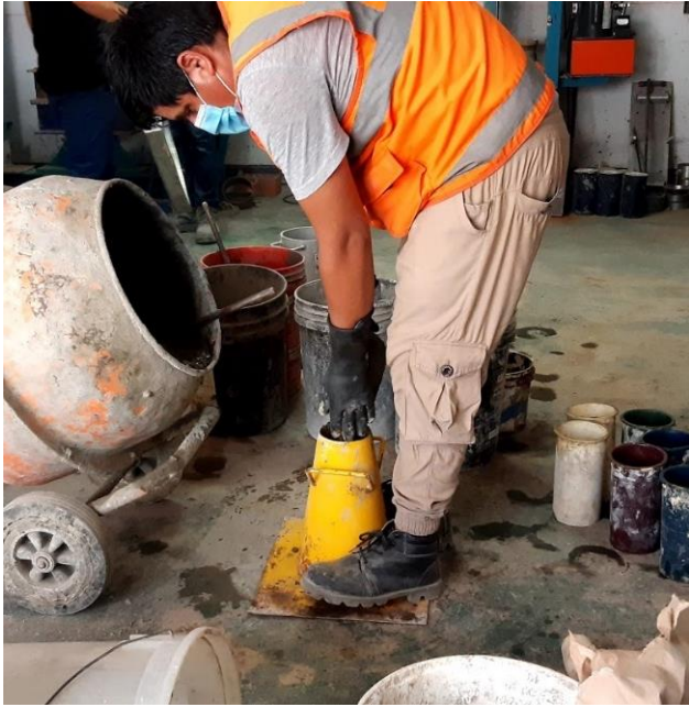
Figura 16. Ensayo del Slump
