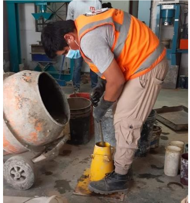
Figura 15. Compactación con varilla
