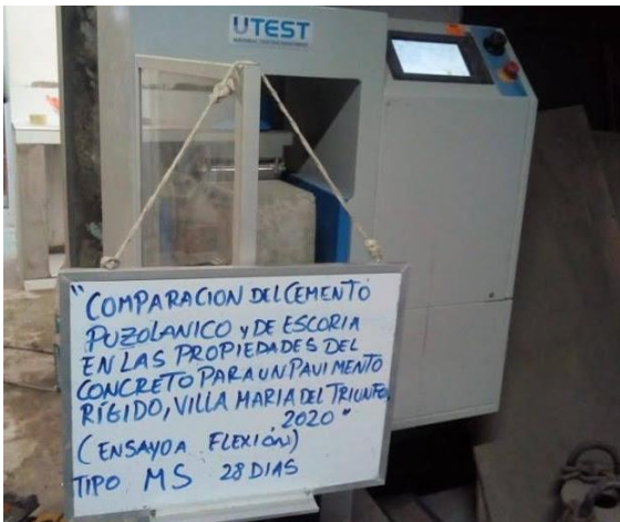
Fotografía 14. Ensayo de resistencia de flexión del concreto tipo MS
