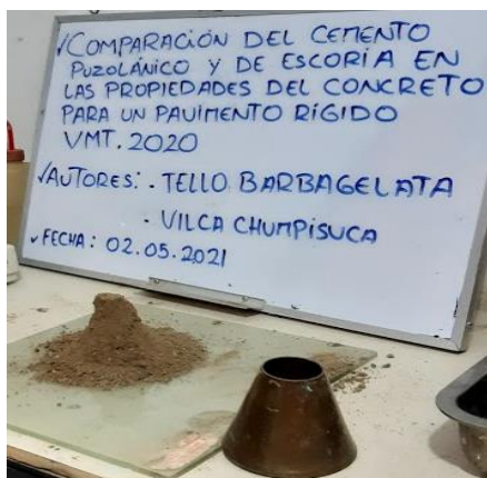
Fotografía 4. Ensayo de absorción
