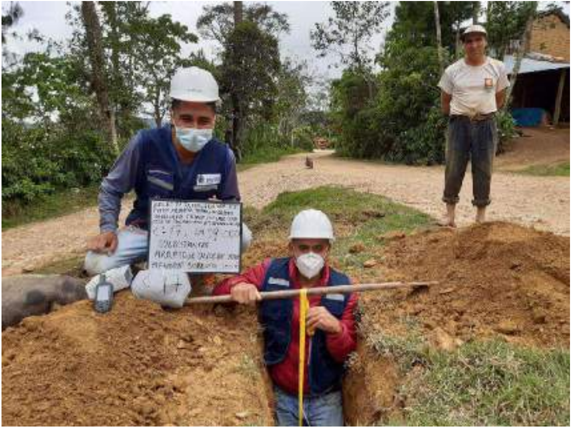
FOTOGRAFIA 17: Se Observa La Toma De Muestras De La C - 17 Para La Tesis: " Diseño De Infraestructura Vial Para Mejorar La Transitabilidad Vehicular Tramo Cutervo –San José De Cullanmayo Km. 00+000 Al Km.10+360, Cajamarca"
