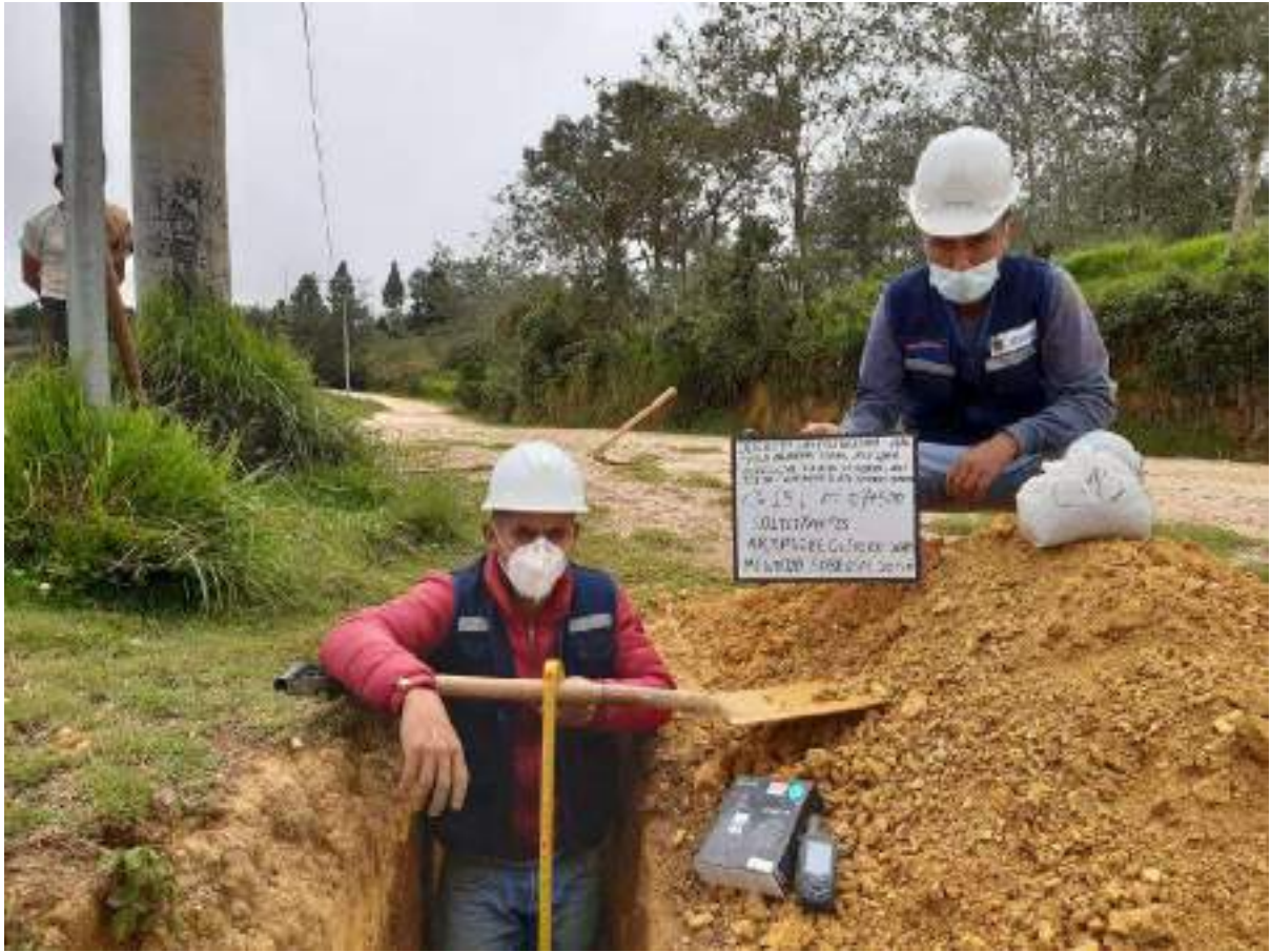
FOTOGRAFIA 15: Se Observa La Toma De Muestras De La C - 15 Para La Tesis: " Diseño De Infraestructura Vial Para Mejorar La Transitabilidad Vehicular Tramo Cutervo –San José De Cullanmayo Km. 00+000 Al Km.10+360, Cajamarca"
