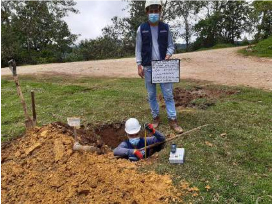
FOTOGRAFIA 01: Se Observa La Toma De Muestras De La C - 1 Para La Tesis: " Diseño De Infraestructura Vial Para Mejorar La Transitabilidad Vehicular Tramo Cutervo –San José De Cullanmayo Km. 00+000 Al Km.10+360, Cajamarca"
