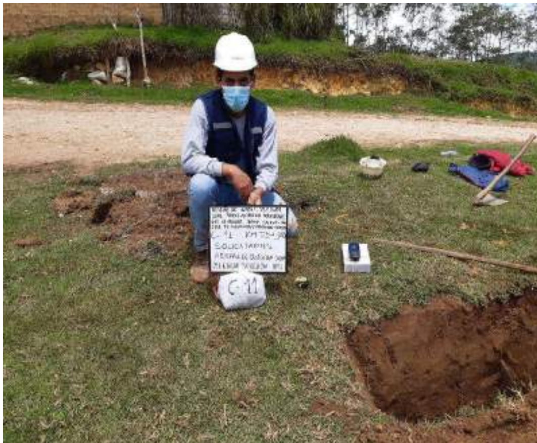
FOTOGRAFIA 11: Se Observa La Toma De Muestras De La C - 11 Para La Tesis: " Diseño De Infraestructura Vial Para Mejorar La Transitabilidad Vehicular Tramo Cutervo –San José De Cullanmayo Km. 00+000 Al Km.10+360, Cajamarca"
