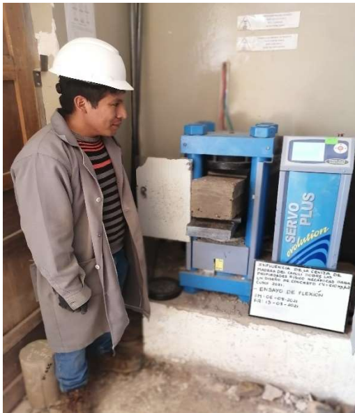
Ensayo de compresión de vigas de concreto
