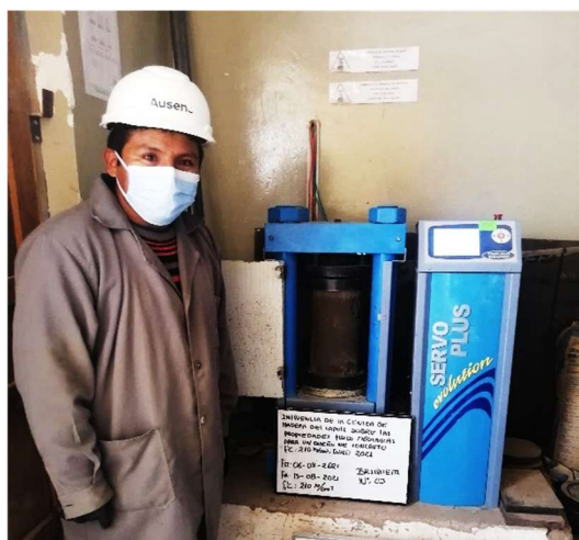
Figura N°17: Prueba de Resistencia a la compresión.
