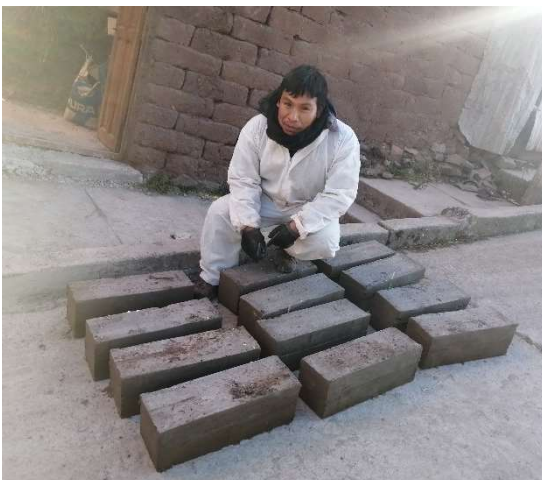
Figura 6: Vigas de hormigón.
