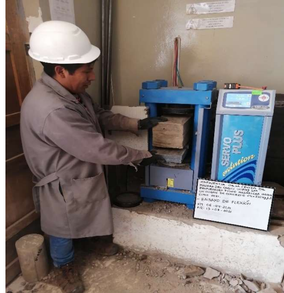
Ensayo de compresión de vigas de concreto
