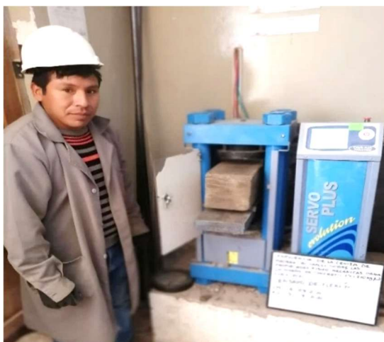
Figura N°20: Ensayo de Flexión.
