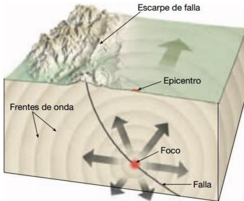
Figura 5: Partes de un Sismo.
