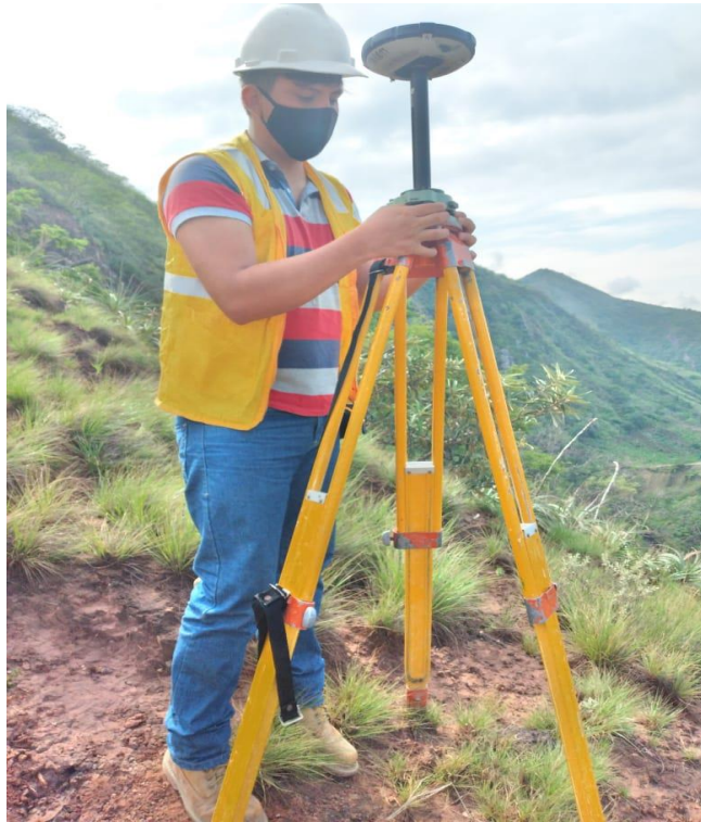
FIGURA 2: Tramo Nueva Victoria – Espital, Km. 0+000 al Km. 5+960, Amazonas – Equipo utilizado en campo por características de la antena GNSS, 2021.
