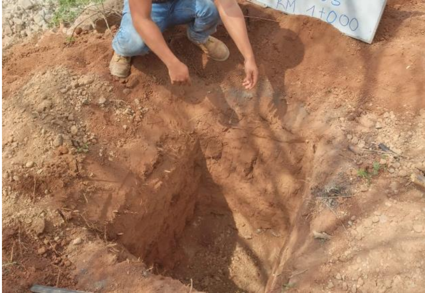
FIGURA 15 : Tramo Nueva Victoria – Espital, Km. 0+000 al Km. 5+960, Amazonas - Fotografía midiendo la profundidad de la Calicata C-5 ,2021.
