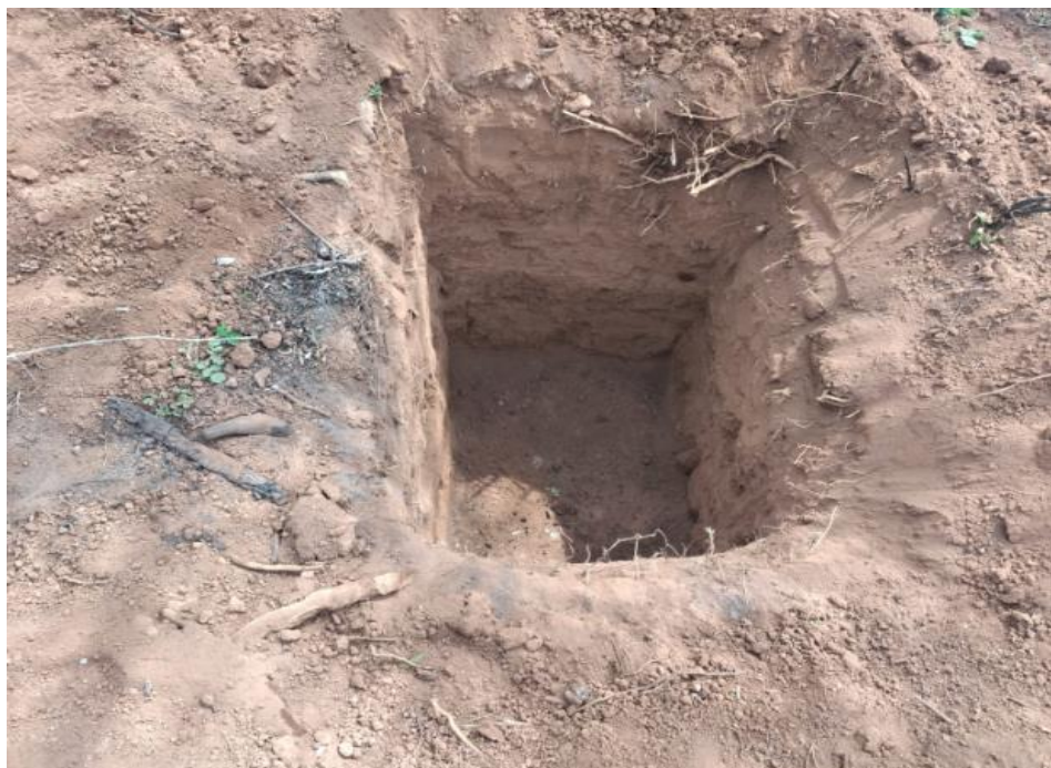
FIGURA 16 : Tramo Nueva Victoria – Espital, Km. 0+000 al Km. 5+960, Amazonas - Fotografía midiendo la profundidad de la Calicata C-5 ,2021.
