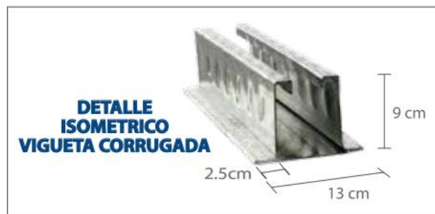
Figura N° 7. Detalle Isometrico de Vigueta Corrugada Pre-fabricada
