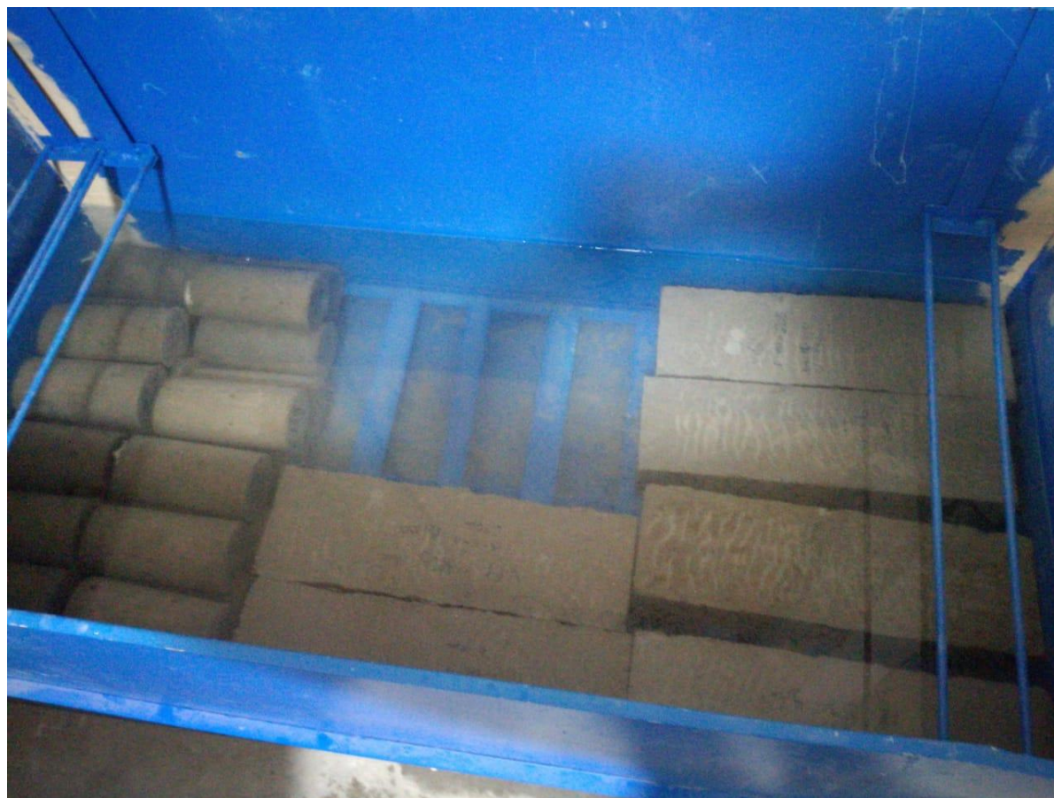
Panel Fotográfico 12. Curado de probetas y viguetas de concreto.
