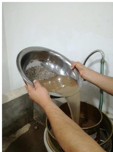
Panel fotográfico 10. Análisis granulométrico de los agregados.
