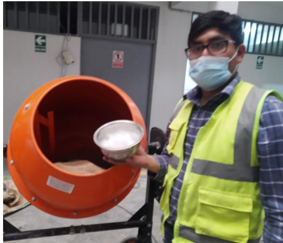
Panel Fotográfico 11. Elaboración de la mezcla de diseño con incorporación de la fibra de polipropileno.
