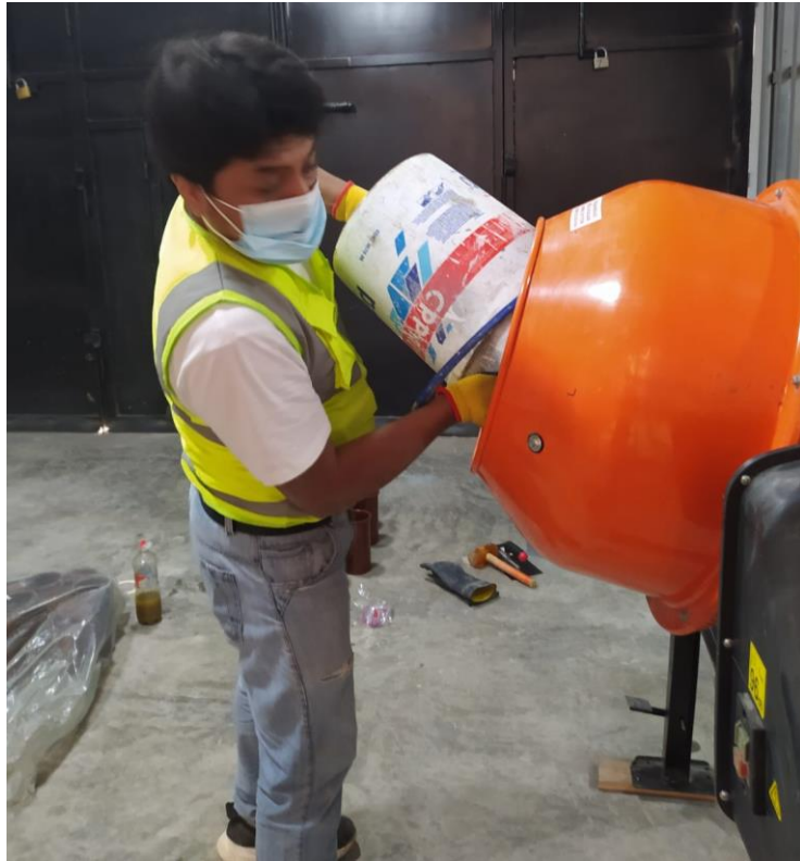
Panel Fotográfico 11. Elaboración de la mezcla de diseño con incorporación de la fibra de polipropileno.
