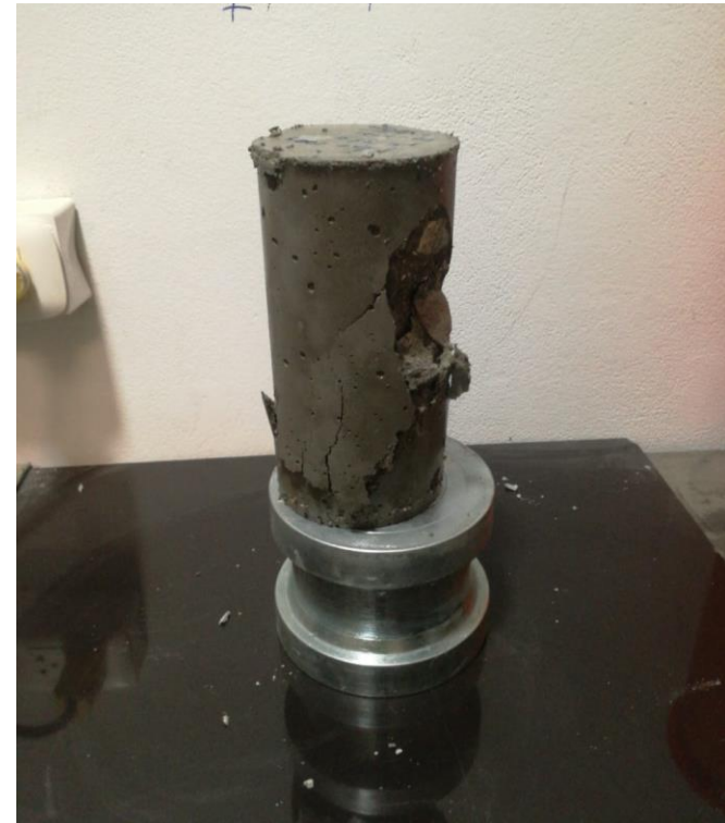
Panel Fotográfico 13. Ensayos de compresión a las probetas de concreto, tomado de datos.
