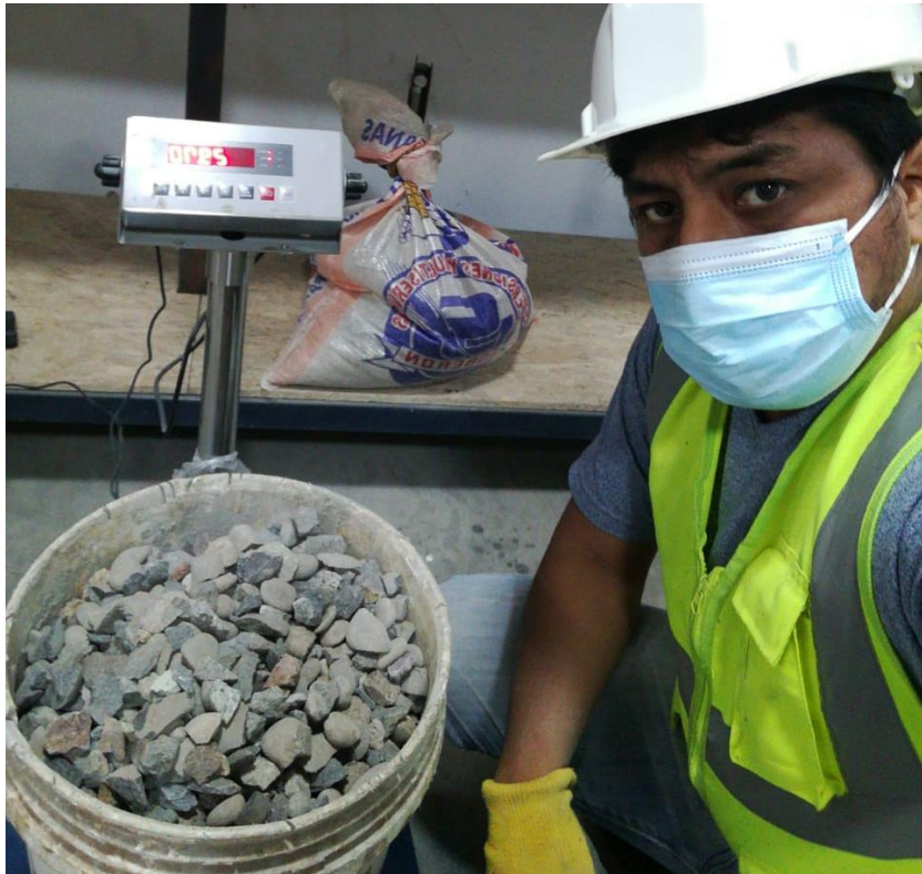
Panel Fotográfico 10. Pesado de los componentes del diseño de nuestra mezcla de diseño.
