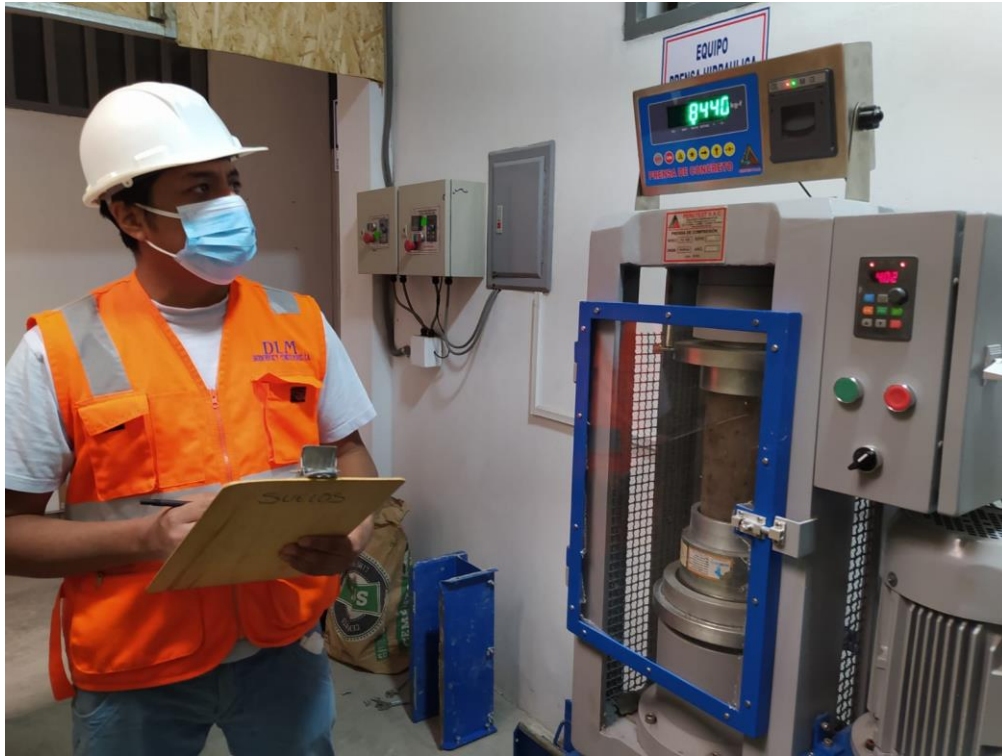
Panel Fotográfico 13. Ensayos de compresión a las probetas de concreto, tomado de datos.
