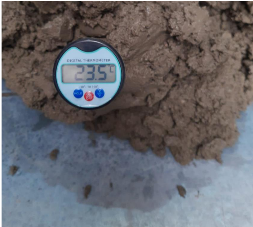
Panel Fotográfico 12. Toma de temperatura y medición de revenimiento de la mezcla de concreto.
