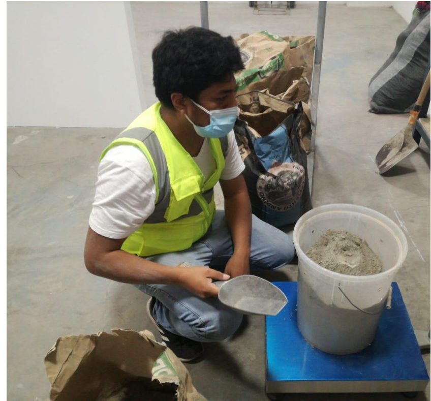
Panel Fotográfico 10. Pesado de los componentes del diseño de nuestra mezcla de diseño.
