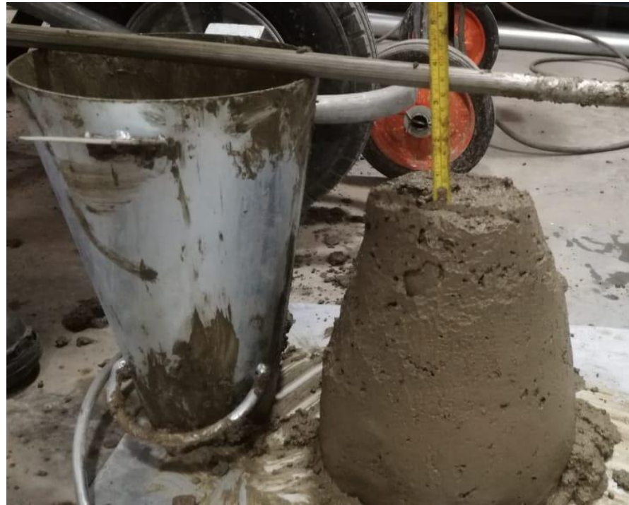
Panel Fotográfico 12. Toma de temperatura y medición de revenimiento de la mezcla de concreto.
