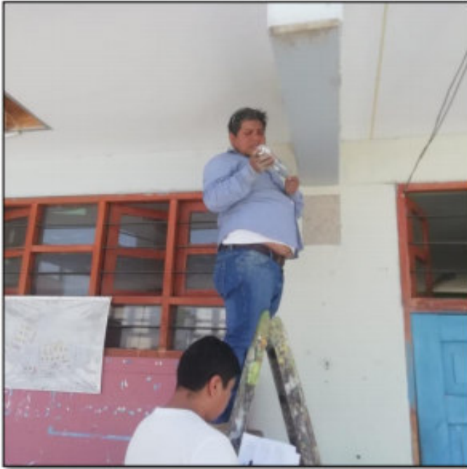
Figura 37. Lectura y anotación de resultados en vigas.
