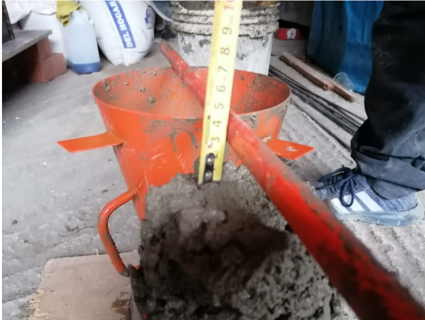
Figura 27. Medición de Slump.
