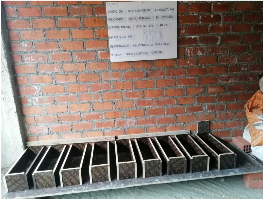
Figura 21. Moldes para vigas encofrado.
