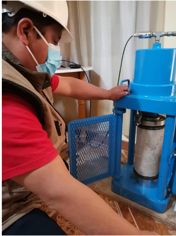
Figura e: Colocación de probetas en la prensa de compresión
