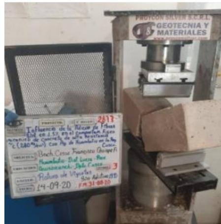
Figura 6. : *Ensayo de Rotura de viguetas*
