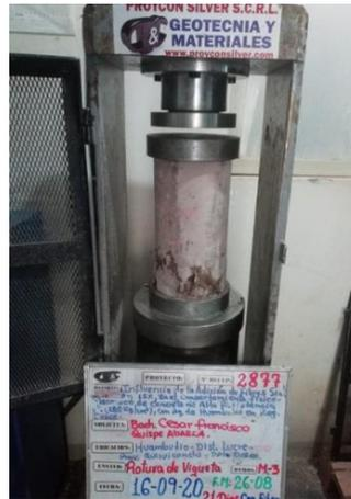
Figura 5. : Ensayo de Rotura de Probetas
