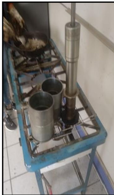
Figura N° 10: Preparación de la mezcla asfáltica
