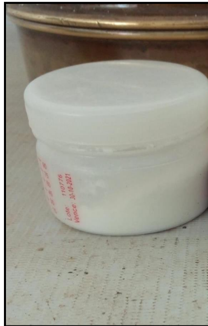
Figura N° 05: Pasado por la malla #200 para análisis de FRX y PH
