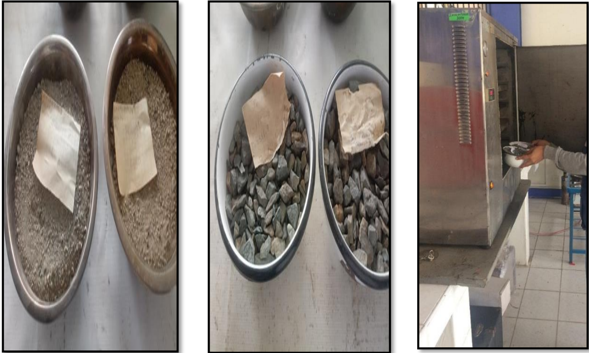
Figura N° 07: Ensayo de contenido de humedad
