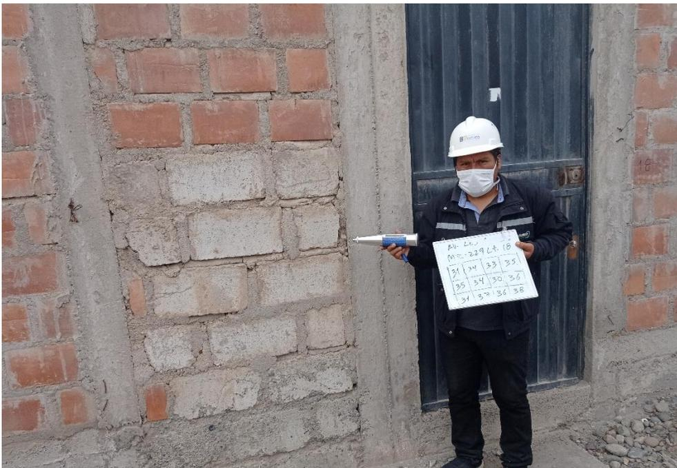
**Fotografía N°34:** Registro de valores emitido por el Esclerómetro.
