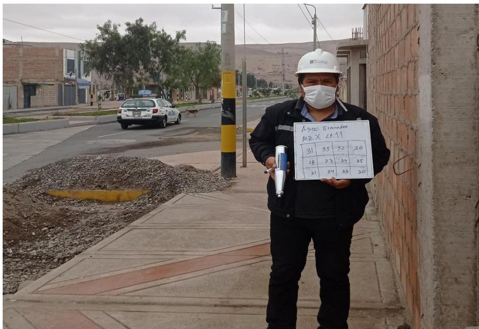
**Fotografía N°09:** Registro de valores emitido por el Esclerómetro.
