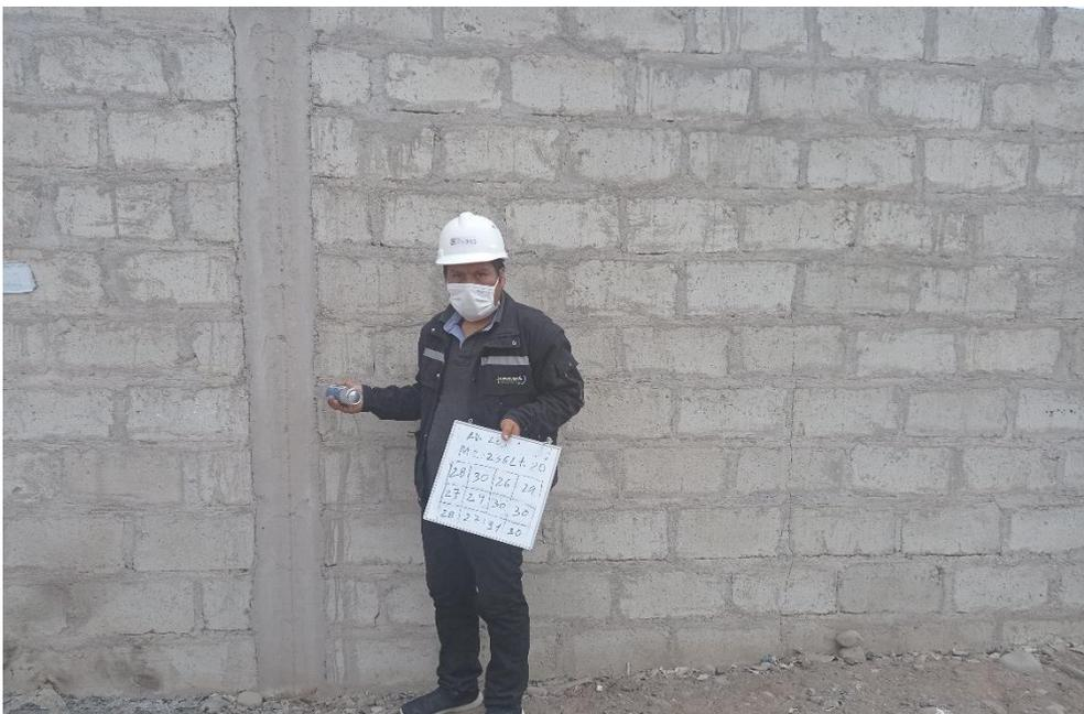
**Fotografía N°36:** Registro de valores emitido por el Esclerómetro.
