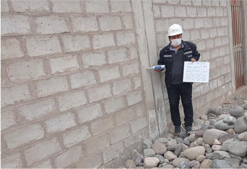
**Fotografía N°27:** Registro de valores emitido por el Esclerómetro.
