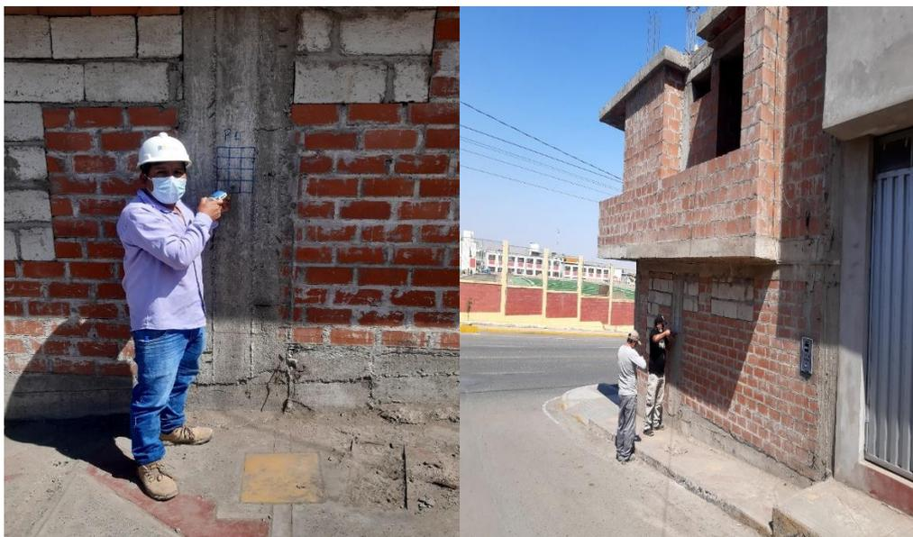
**Fotografía N°02:** Procedimientos previos al ensayo de Esclerometría.
