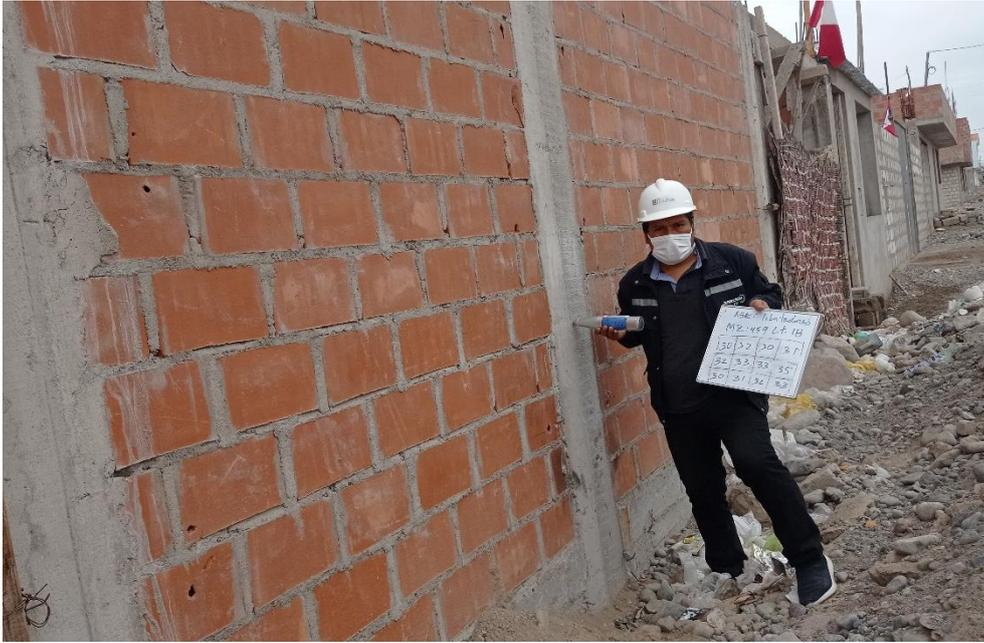
**Fotografía N°21:** Registro de valores emitido por el Esclerómetro.
