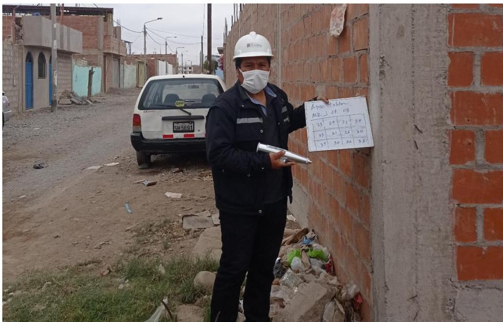
**Fotografía N°12:** Registro de valores emitido por el Esclerómetro.
