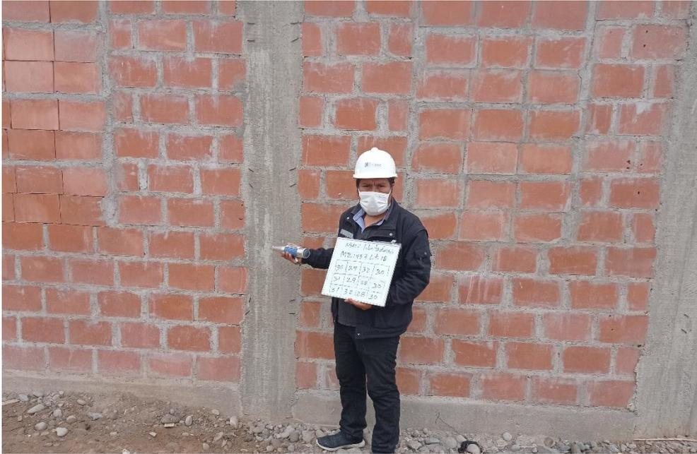
**Fotografía N°23:** Registro de valores emitido por el Esclerómetro.
