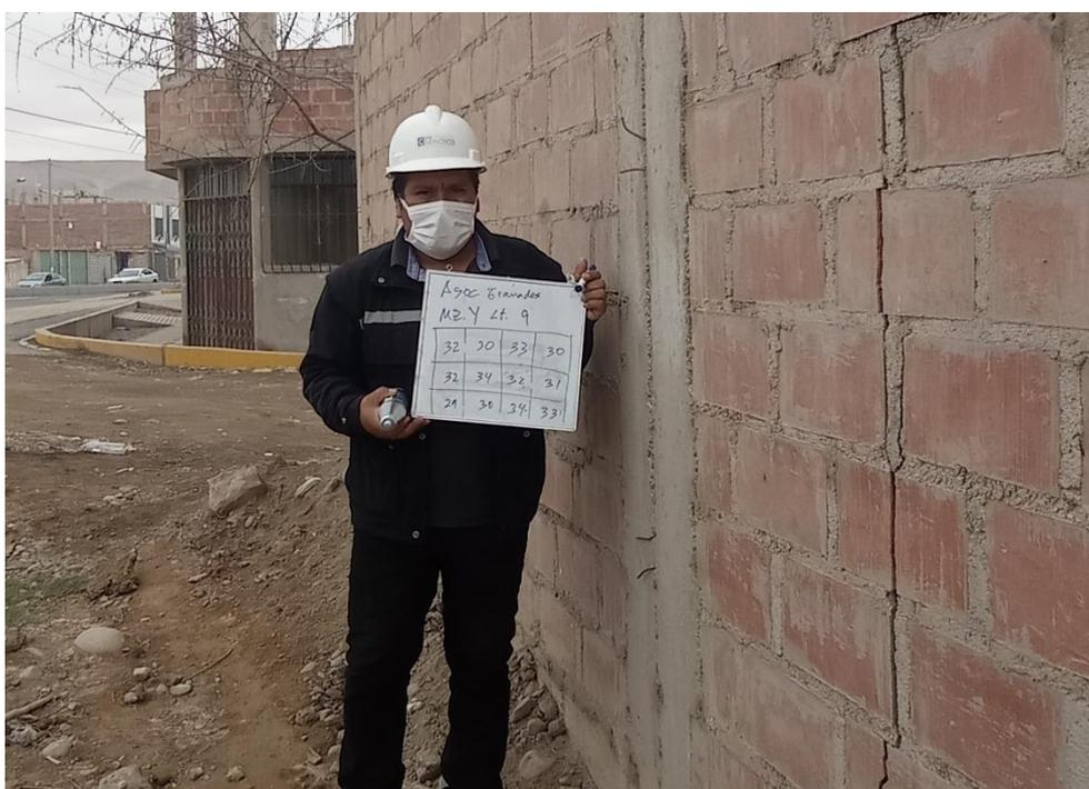
**Fotografía N°10:** Registro de valores emitido por el Esclerómetro.
