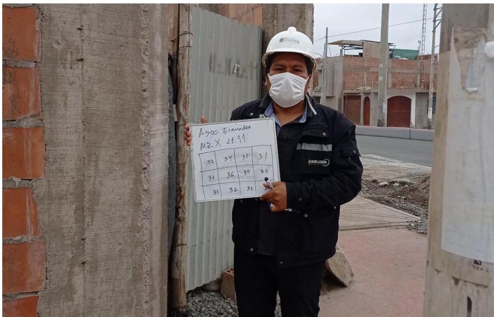
**Fotografía N°08:** Registro de valores emitido por el Esclerómetro.
