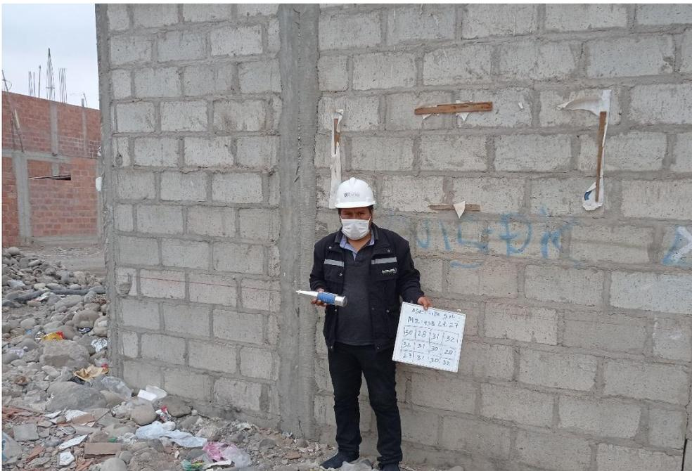
**Fotografía N°26:** Registro de valores emitido por el Esclerómetro.
