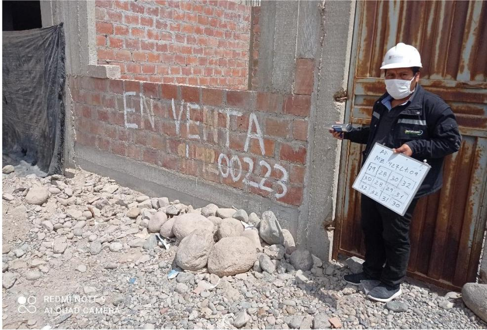
**Fotografía N°41:** Registro de valores emitido por el Esclerómetro.
