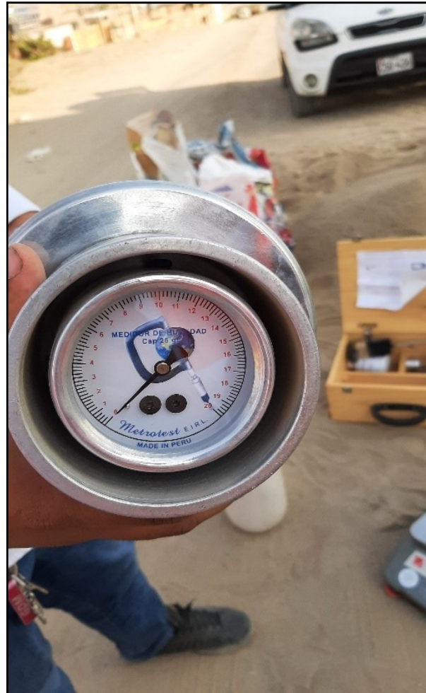
Figura 15. Medidor de humedad Speedy en campo.
