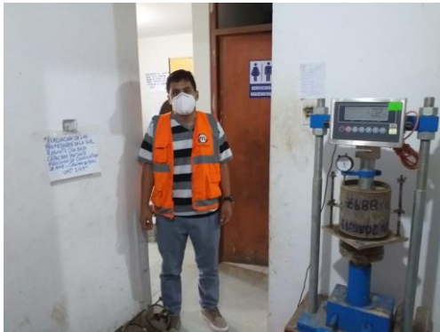
Ensayo de CBR
