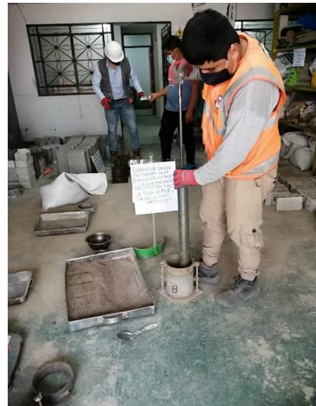
Compactación con el pisón a 25 golpes uniformemente.
