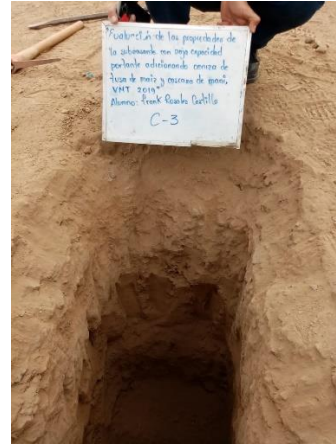
Excavación de la tercera calicata con 1.50m de profundidad
