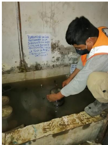
Ensayo de CBR
