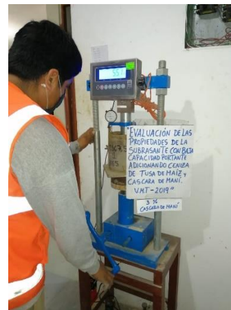
Prensa CBR en la muestra adicionando el 3% de cáscara de maní
