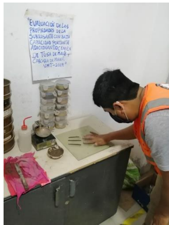
Ensayo de Límite plástico
