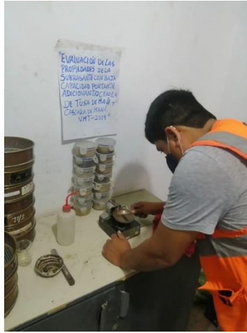
Ensayo de límite líquido, enrasado de la muestra en la copa de Casagrande
