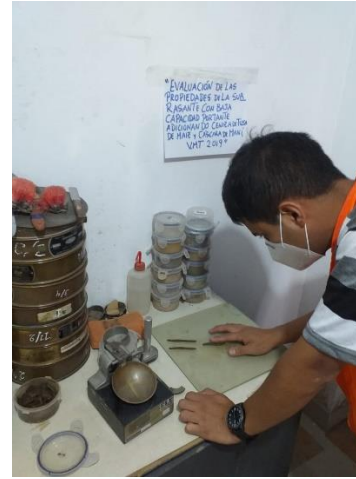
Ensayo de Límite plástico, amasado de la muestra en forma cilíndrica de 3mm de diámetro.
