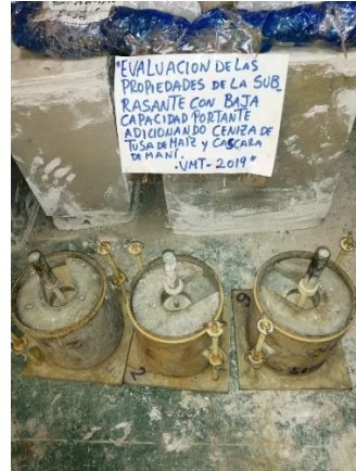
Ensayo de CBR
