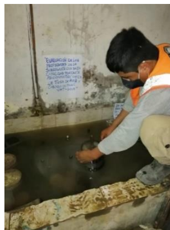
Introduciendo el molde bajo el agua durante 4 días para calcular su expansión.
