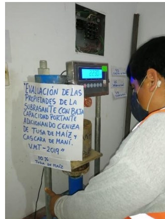
Prensa CBR en la muestra adicionando el 10% de tusa de maíz
