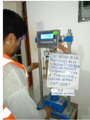
Prensa CBR en la muestra adicionando el 9% de cáscara de maní
