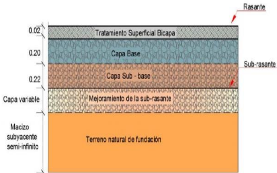
Figura 1: Sección transversal – Pavimento Flexible, 2008
