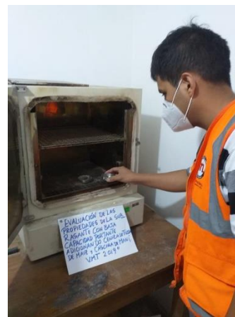
Muestra llevada al horno para su secado
