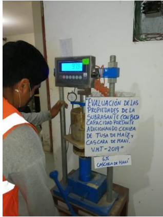
Prensa CBR en la muestra adicionando el 6% de cáscara de maní
