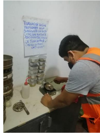
Enrasado de material en la copa de Casagrande
