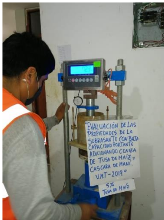
Prensa CBR en la muestra adicionando el 5% de tusa de maíz
