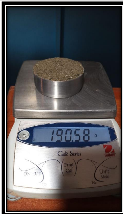
Figura N° 28 Ensayo realizado por JGR'B Ingenieros S.R.L - Ensayo de Corte Directo.
