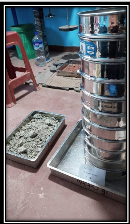
Figura N° 27 Ensayo realizado por JGR'B Ingenieros S.R.L – Ensayo de Granulometría.
