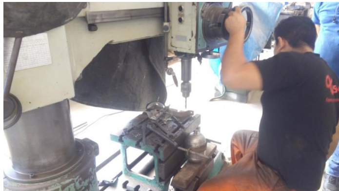
Figura 4. Trabajador sin EPP.
