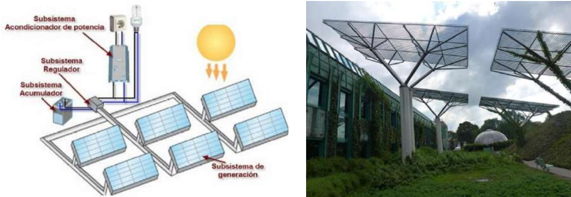
Figura: Sistema fotovoltaico
