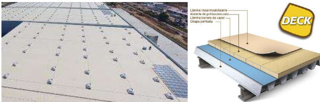
Figura: Sistema de cubiertas deck
