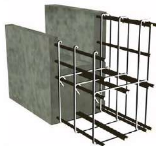
Figura: Vigas de sistema aporticado.
