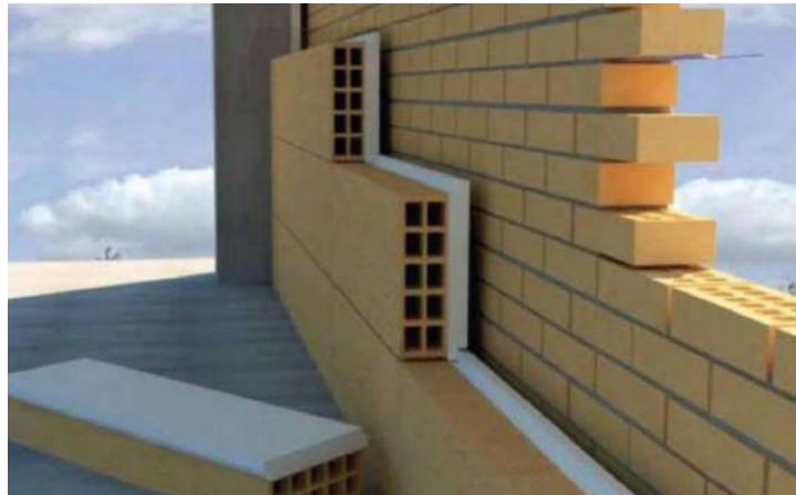
Figura: Sistema autoportante.
