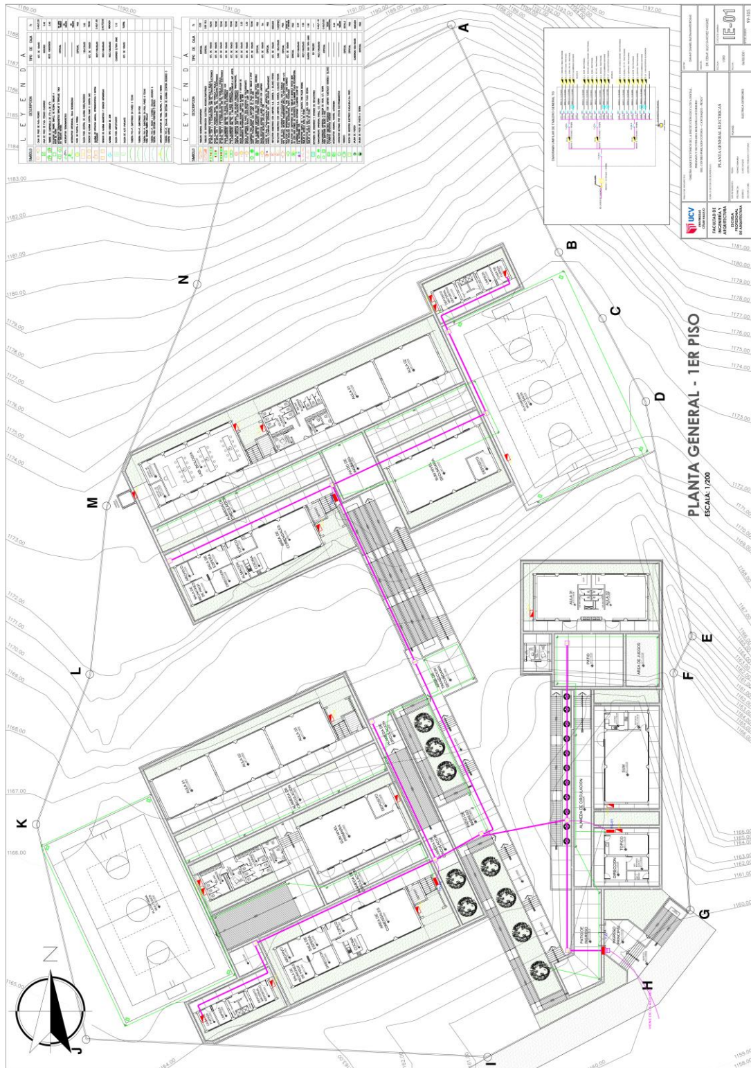
IMAGEN N°118: PLANO INSTALACIÓN ELÉCTRICA EXTERIOR
