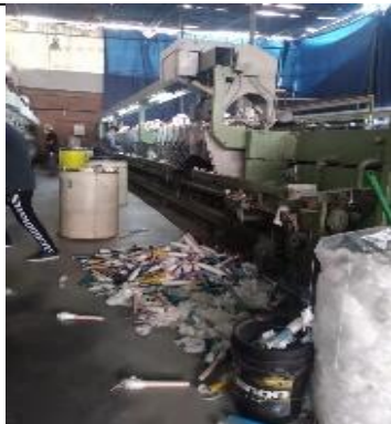
Pasadizo entre continua y conera sucias con restos de Huaipes
