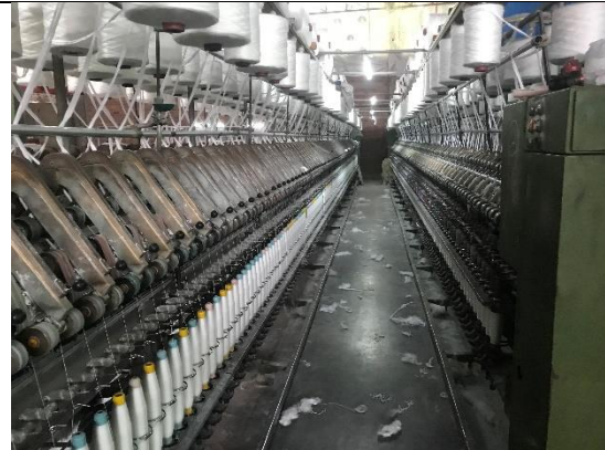
Pasadizo de continuas sucias con restos de huaipes
