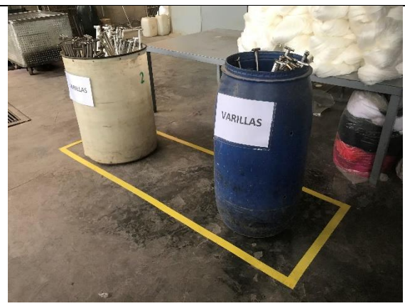
Demarcación de zona de varillas con sus respectivos tachos
