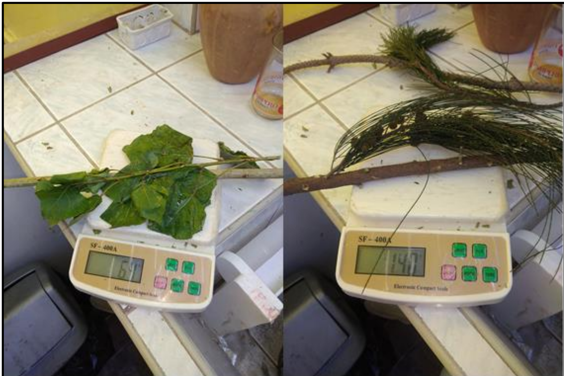
Figura 27: Las muestras fueron reducidas y se tomaron el peso inicial ante de ser enviadas al laboratorio para su determinación de humedad relativa.
