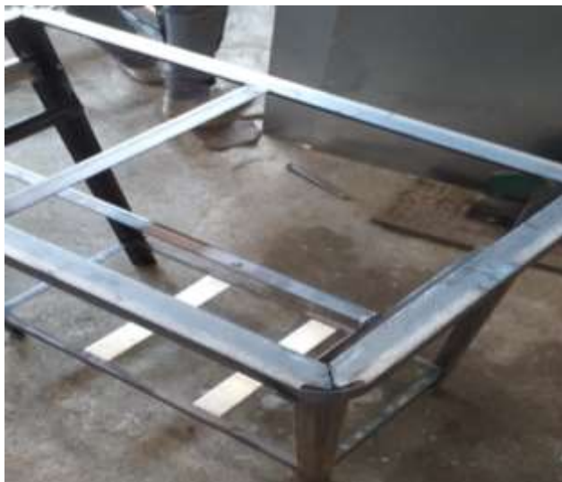
Anexo N° 10: Estructura de la cocina de dos hornillas.
