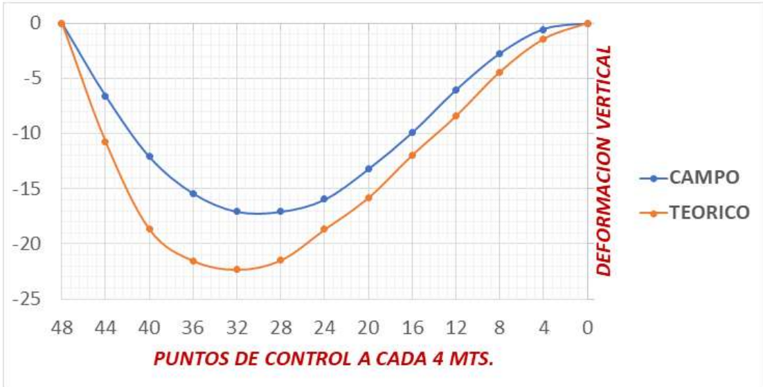
Figura N° 83. Control en Campo - Colocacion del Quinto Paño de Losa de Concreto
