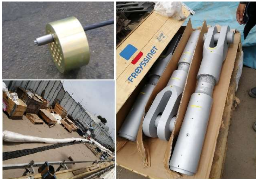
Figura N° 21. Elementos Mecánicos de los Tirantes
