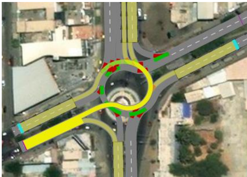
Figura 14. Modelamiento de las rutas vehiculares de situación con proyecto - Ovalo “Las Capullanas” - VISSIM 2021 Student Version
