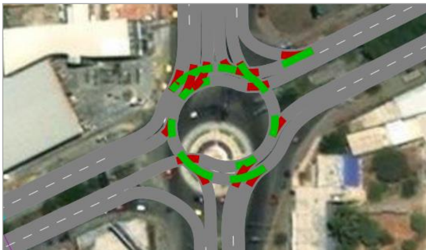
Figura 13. Modelamiento geométrico de situación con proyecto – Turbo rotonda para el Ovalo “Las Capullanas” - VISSIM 2021 Student Version
