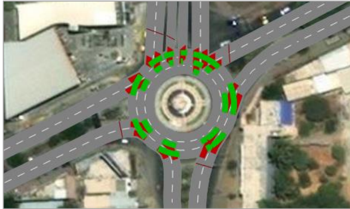
Figura 10. Modelamiento geométrico de situación sin proyecto - Ovalo “Las Capullanas” - VISSIM 2021 Student Version
