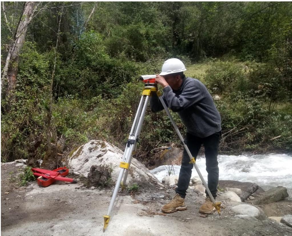
Ilustración 20: Levantamiento topográfico línea de conducción.
