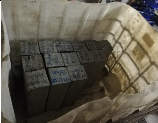
Imagen 19: Pobetas de concreto Prismaticas, Sin adición y Con adición de Cenizas volantes, Curado
