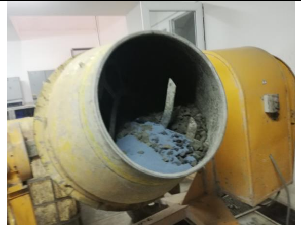
Imagen 10: Adición de Cenizas Volantes en la mezcla de concreto
