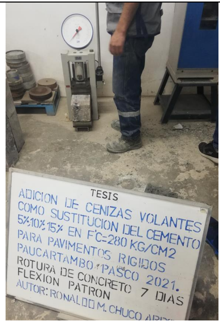
Imagen 32: Rotura del concreto Patrón Prismaticas (flexion) Sin adición de Cenizas Volantes 7 días
