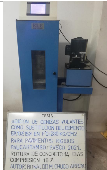
Imagen 30: Rotura del concreto Cilindricas (Compresión) 15% de adición de Cenizas Volantes 14 días
