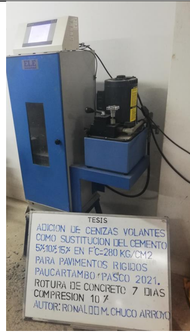
Imagen 26: Rotura del concreto Cilindricas (Compresión) 10% de adición de Cenizas Volantes 7 días
