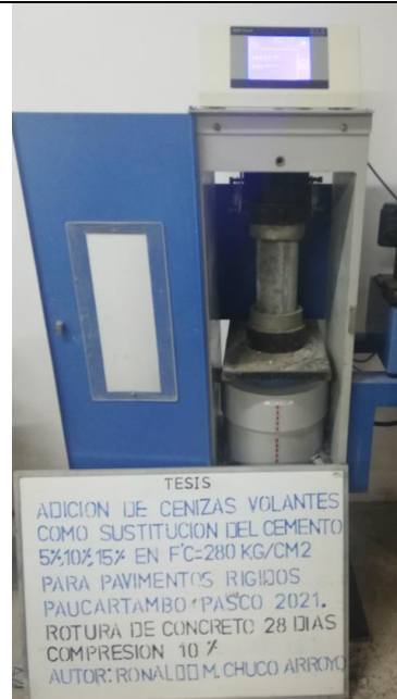
Imagen 28: Rotura del concreto Cilindricas (Compresión) 10% de adición de Cenizas Volantes 28 días
