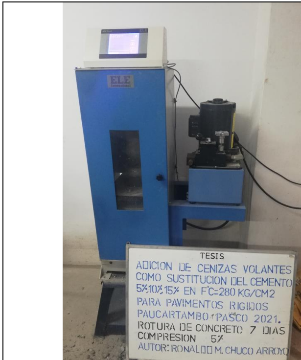
Imagen 23: Rotura del concreto Cilindricas (Compresión) 5% de adición de Cenizas Volantes 7 días
