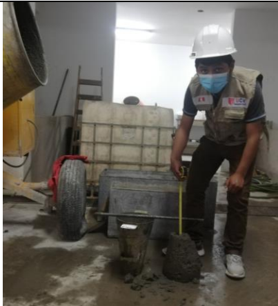
Imagen 11: Medicion de la Mezcla de concreto(Asentamiento) Metodo Slump
