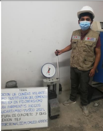
Imagen 41: Rotura del concreto Prismaticas (flexión) 15% de adición de Cenizas Volantes 7 días
