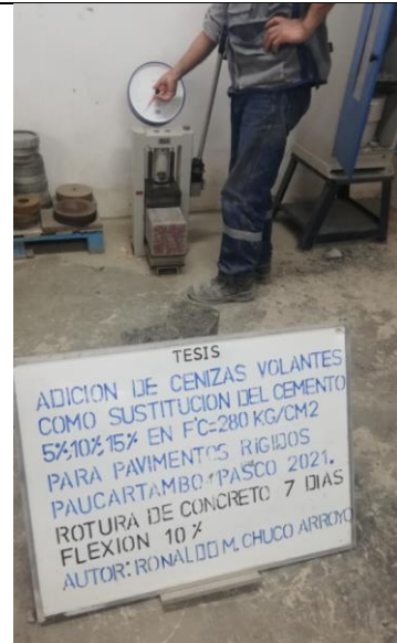
Imagen 36: Rotura del concreto Prismaticas (flexión) 5% de adición de Cenizas Volantes 14 días
