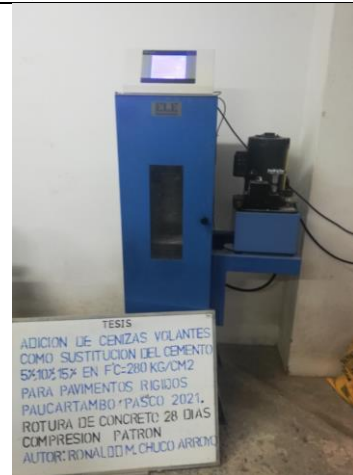
Imagen 22: Rotura del concreto Patrón Cilindricas (Compresión) Sin adición de Cenizas Volantes 28 días
