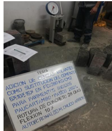
Imagen 40: Rotura del concreto Prismaticas (flexión) 10% de adición de Cenizas Volantes 28 días
