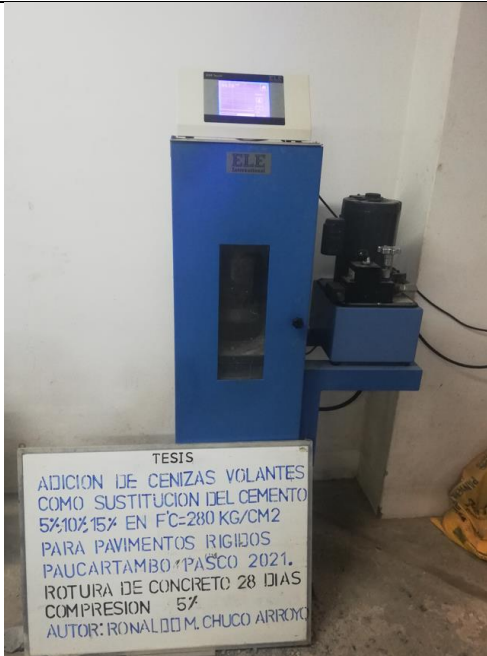
Imagen 25: Rotura del concreto Cilindricas (Compresión) 5% de adición de Cenizas Volantes 28 días
