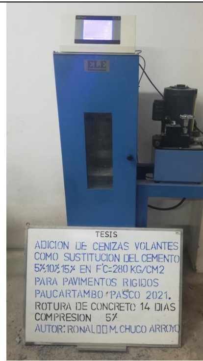
Imagen 24: Rotura del concreto Cilindricas (Compresión) 5% de adición de Cenizas Volantes 14 días
