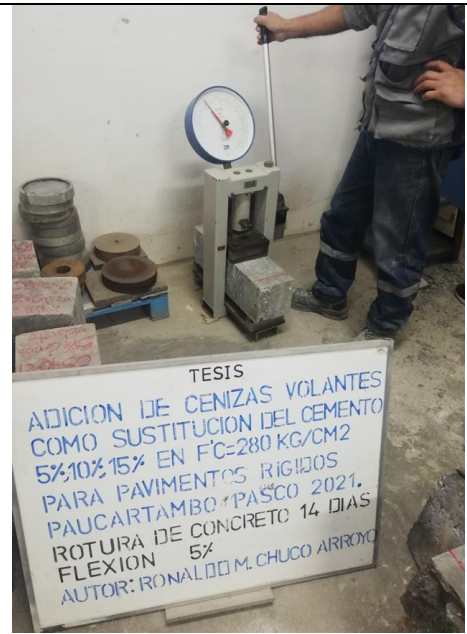
Imagen 36: Rotura del concreto Prismaticas (flexión) 5% de adición de Cenizas Volantes 14 días
