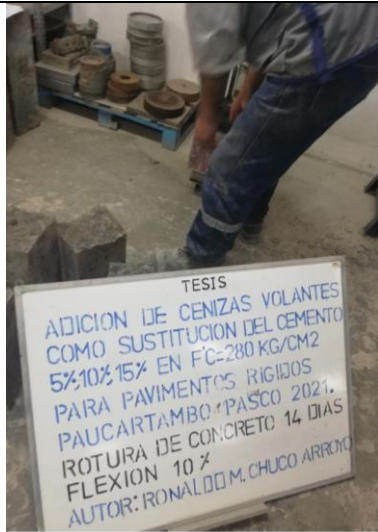
Imagen 39: Rotura del concreto Prismaticas (flexión) 10% de adición de Cenizas Volantes 14 días
