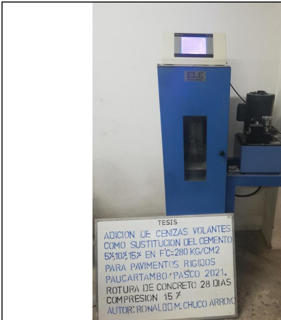
Imagen 31: Rotura del concreto Cilindricas (Compresión) 15% de adición de Cenizas Volantes 28 días
