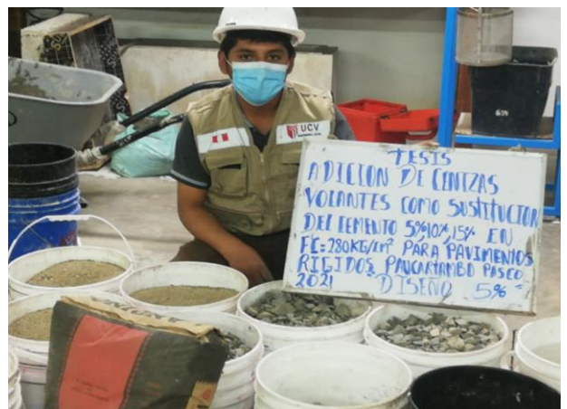
Imagen 4: Diseño de Concreto 5% Adición de CV
