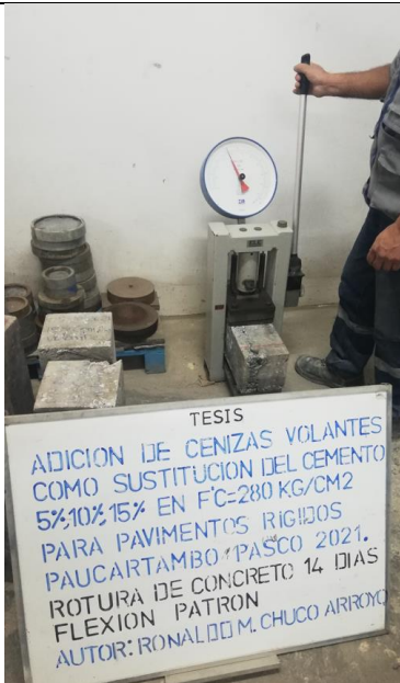
Imagen 33: Rotura del concreto Patrón Prismaticas (flexión) Sin adición de Cenizas Volantes 14 días
