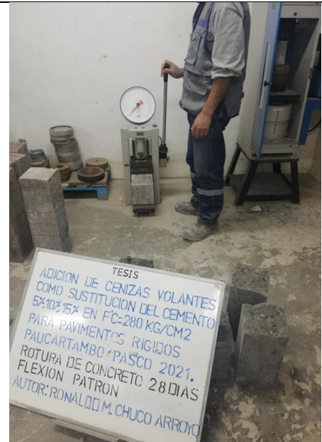
Imagen 34: Rotura del concreto Patrón Prismaticas (flexion) Sin adición de Cenizas Volantes 28 días
