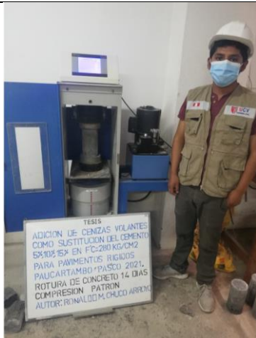
Imagen 21: Rotura del concreto Patrón Cilindricas (Compresión) Sin adición de Cenizas Volantes 14 días
