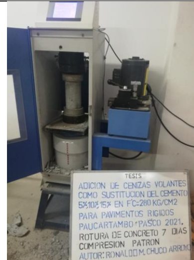
Imagen 20: Rotura del concreto Patrón Cilindricas (Compresión) Sin adición de Cenizas Volantes 7 días
