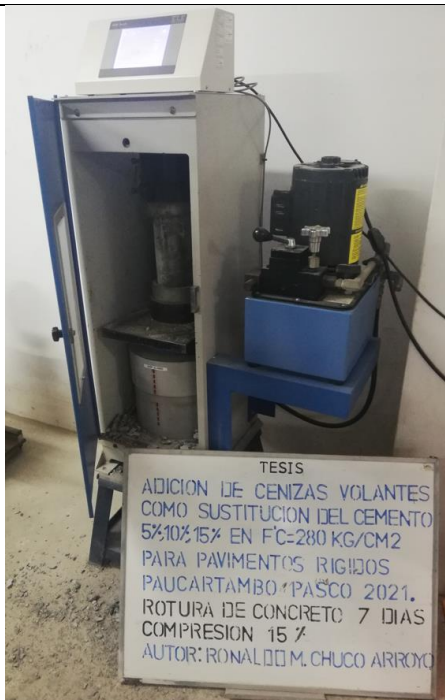
Imagen 29: Rotura del concreto Cilindricas (Compresión) 15% de adición de Cenizas Volantes 7 días
