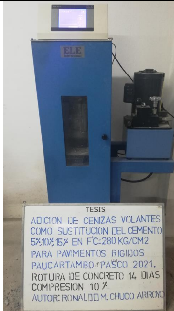
Imagen 27: Rotura del concreto Cilindricas (Compresión) 10% de adición de Cenizas Volantes 14 días
