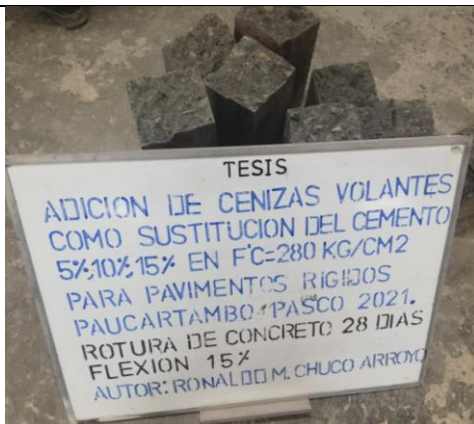
Imagen 43: Rotura del concreto Prismaticas (flexión) 15% de adición de Cenizas Volantes 28 días
