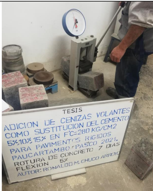
Imagen 35: Rotura del concreto Prismaticas (flexión) 5% de adición de Cenizas Volantes 7 días
