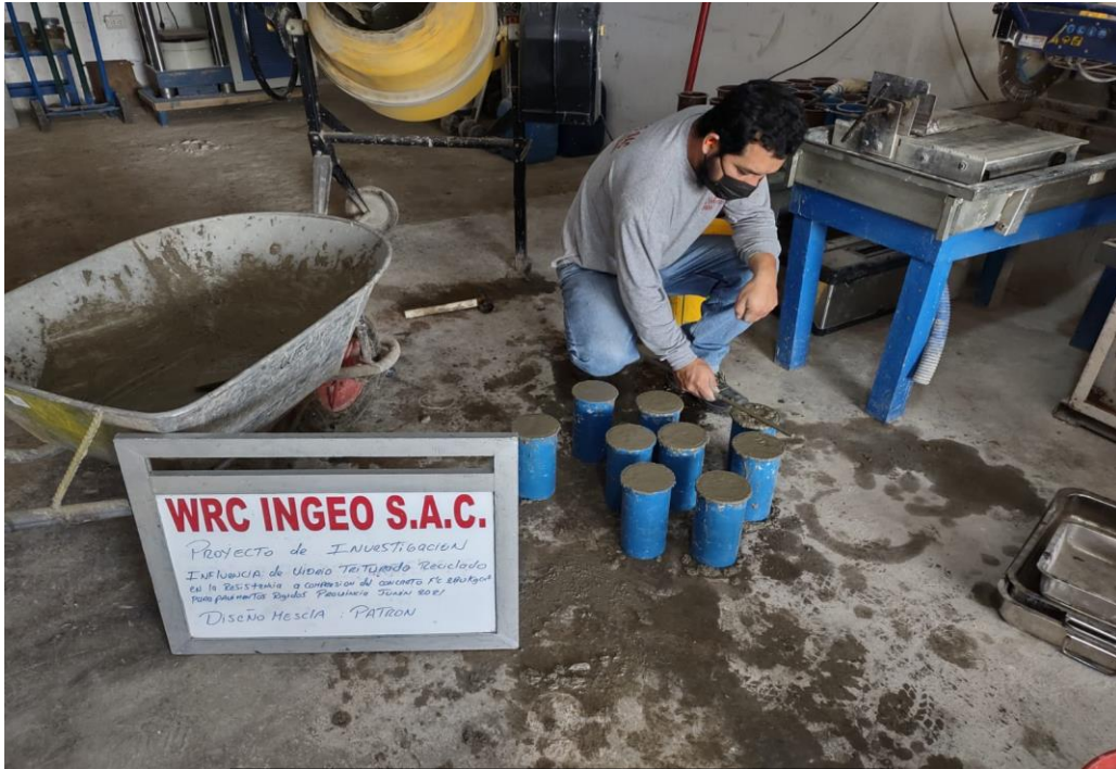
Elaboración de probetas del concreto patrón.
