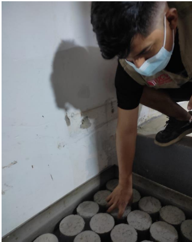
Curado de las probetas de concreto.
