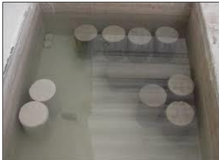
Figura 13. Curado del concreto
