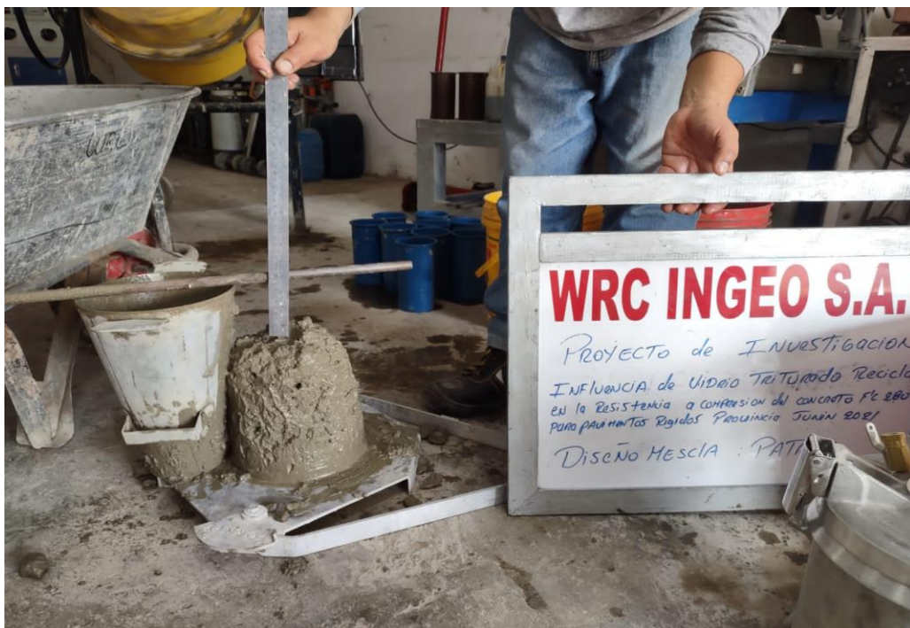
Prueba Slump del concreto patrón.
