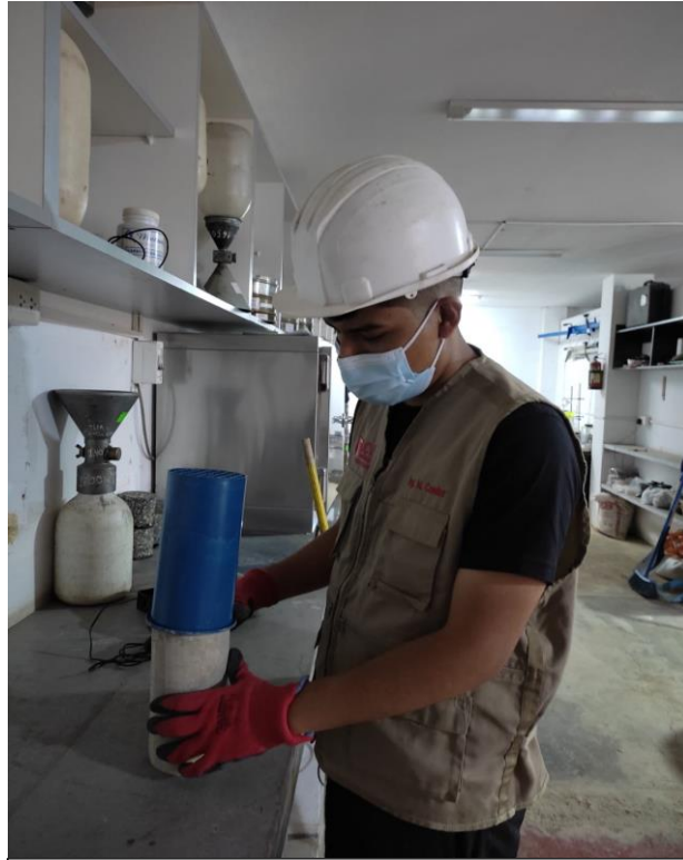
Probetas de concreto retirado del molde.
