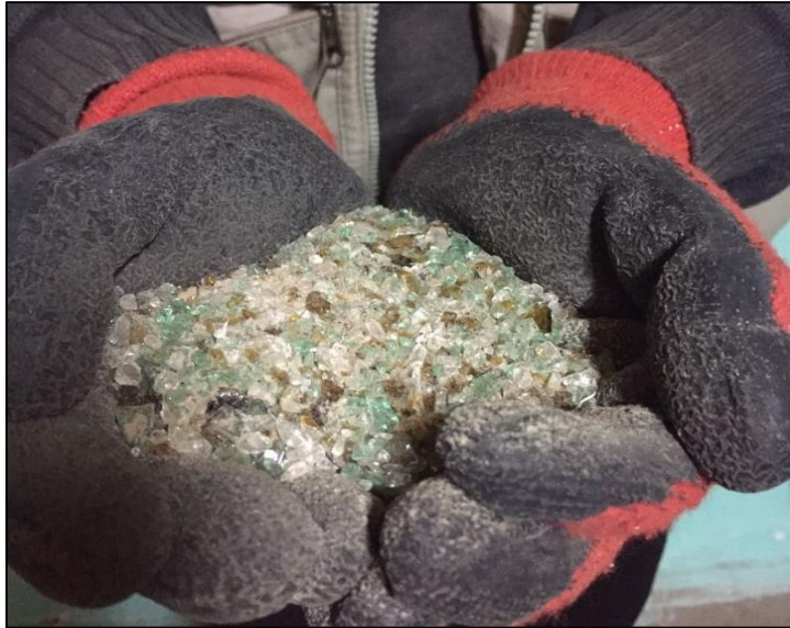
Figura 8. Vidrio como agregado en el concreto
