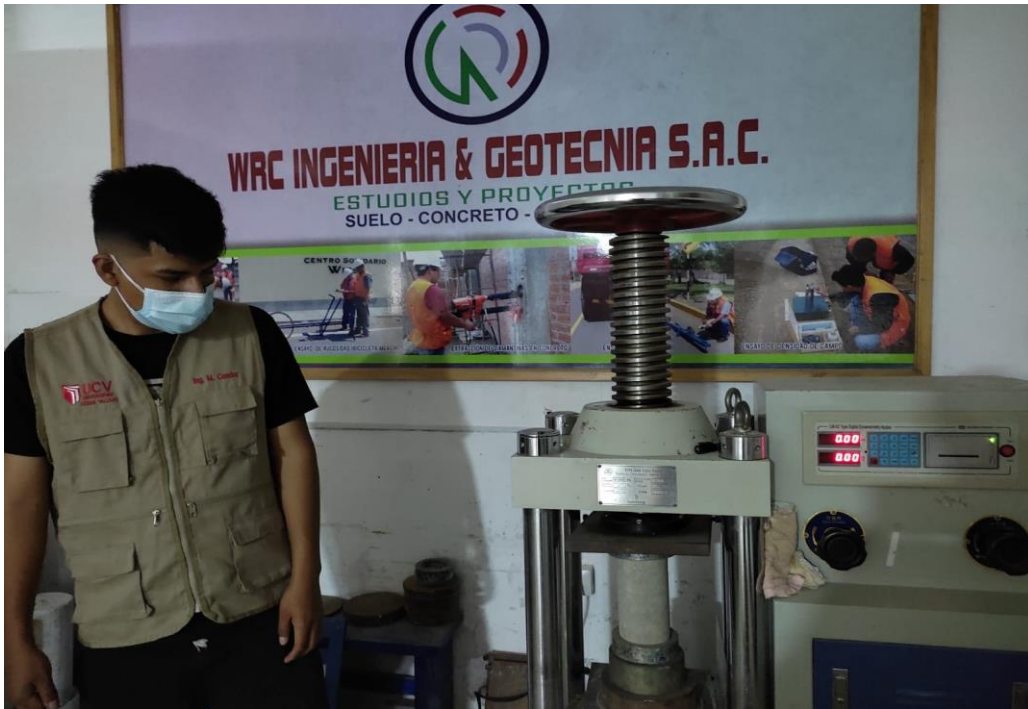
Ensayo de resistencia a compresión.
