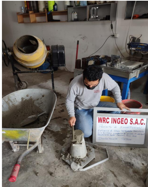
Prueba Slump del concreto patrón.
