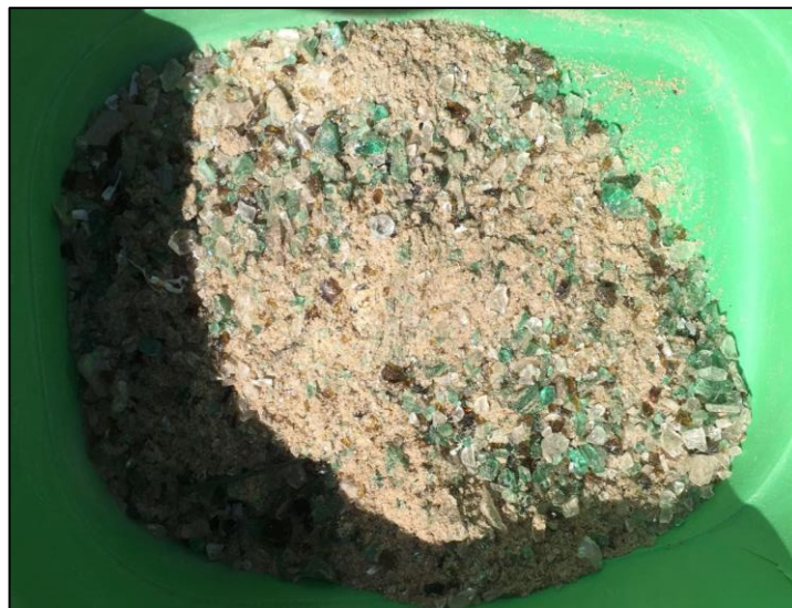
Figura 3. Utilización de vidrio desechado en el concreto
