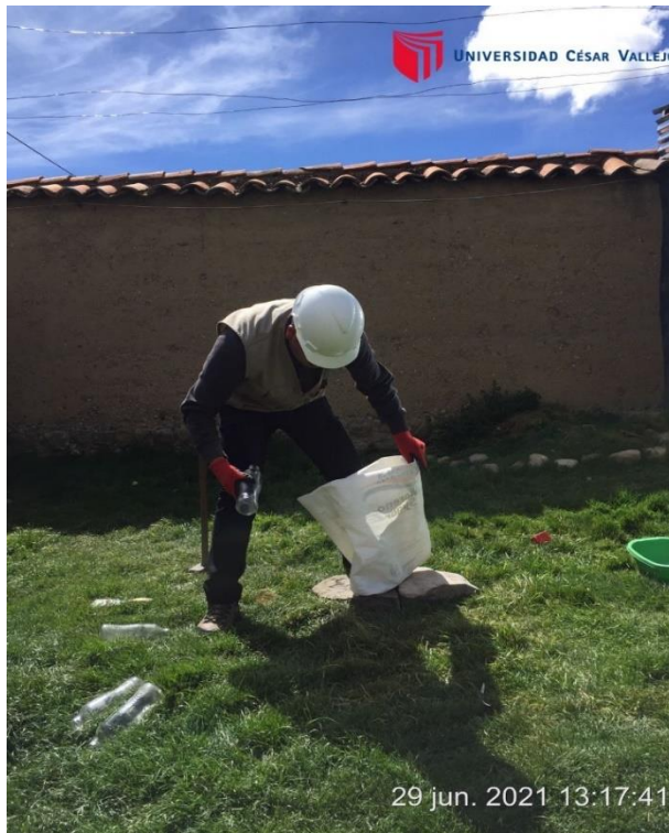
Proceso de trituramiento de vidrio reciclado
