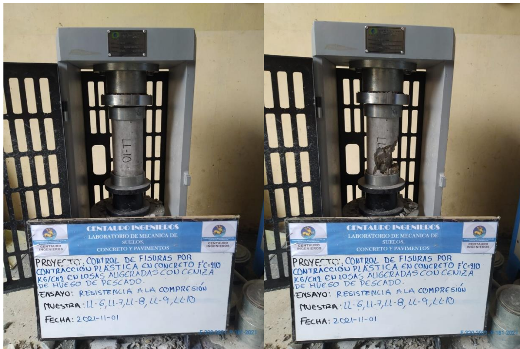
Figura 18: Roturas de probetas de ensayo a compresión.
