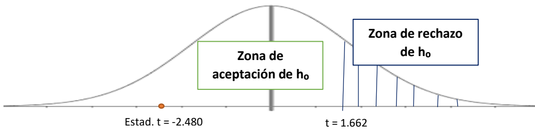
Figura 63: Diagrama de decisión de h_0 de espesor de fisuras de L.A. PATRÓN y L.A. CON 3% CHP de paño de prueba 2
