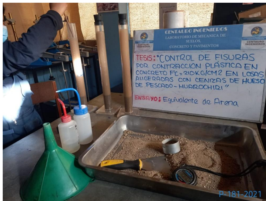
Figura 15: Ensayo de equivalente de arena
