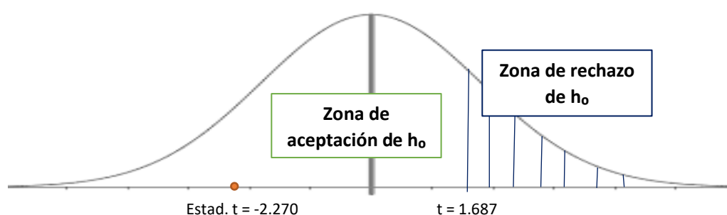
Figura 66: Diagrama de decisión de h_0 de longitud de fisuras de L.A. PATRÓN y L.A. CON 6% CHP de paño de prueba 1
