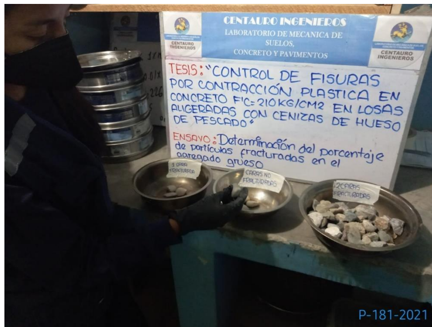
Figura 16: Ensayo para determinar el % de caras fracturadas
