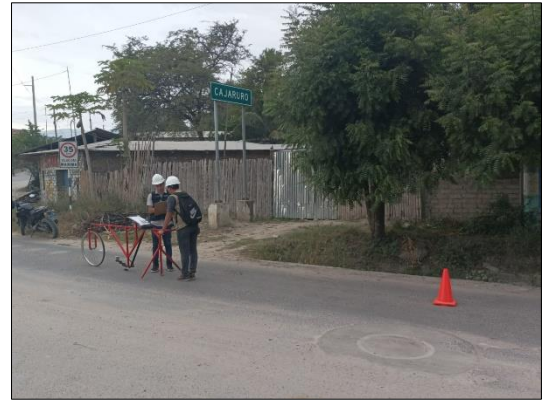
Figura 10. Realización de ensayo con rugosímetro de Merlin, carril izquierdo, lado derecho (ingreso a Cajamaruro)
