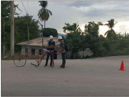
Figura 9. Realización de ensayo con rugosímetro de Merlin, carril izquierdo, lado derecho (salida a Bagua Grande)
