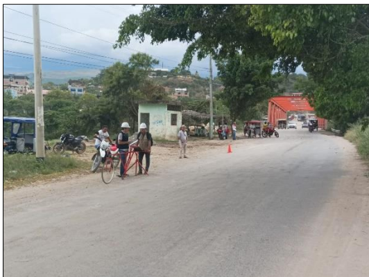
Figura 7. Inicio de ensayo con rugosímetro de Merlin, primer tramo del carril derecho-lado derecho.
