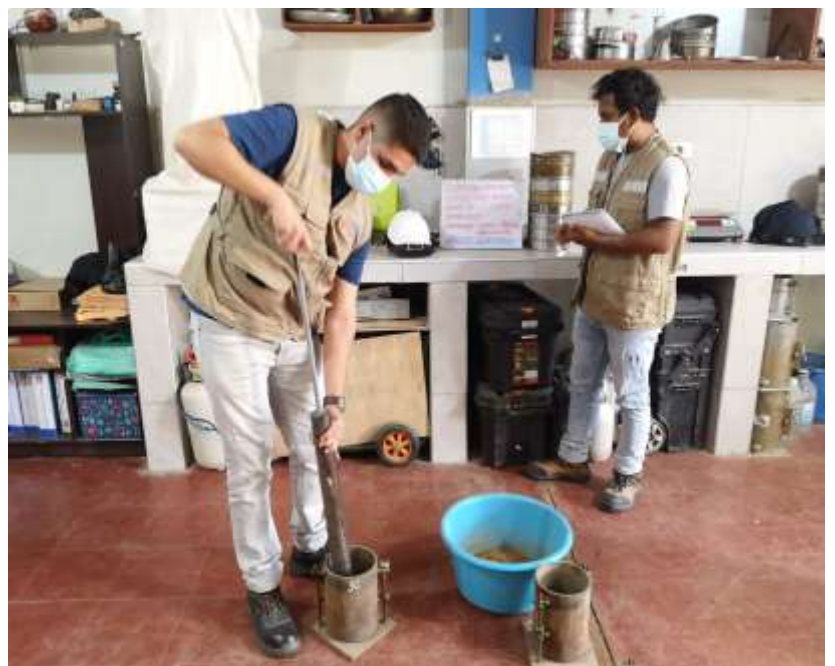
Ensayo del Proctor modificado , iniciando el proceso de compactación con 26 golpes hasta completar las 3 capas.
