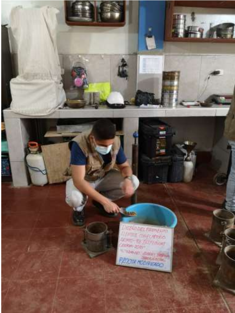
Ensayo del Proctor modificado , colocando la muestra al molde para iniciar el proceso de compactación.
