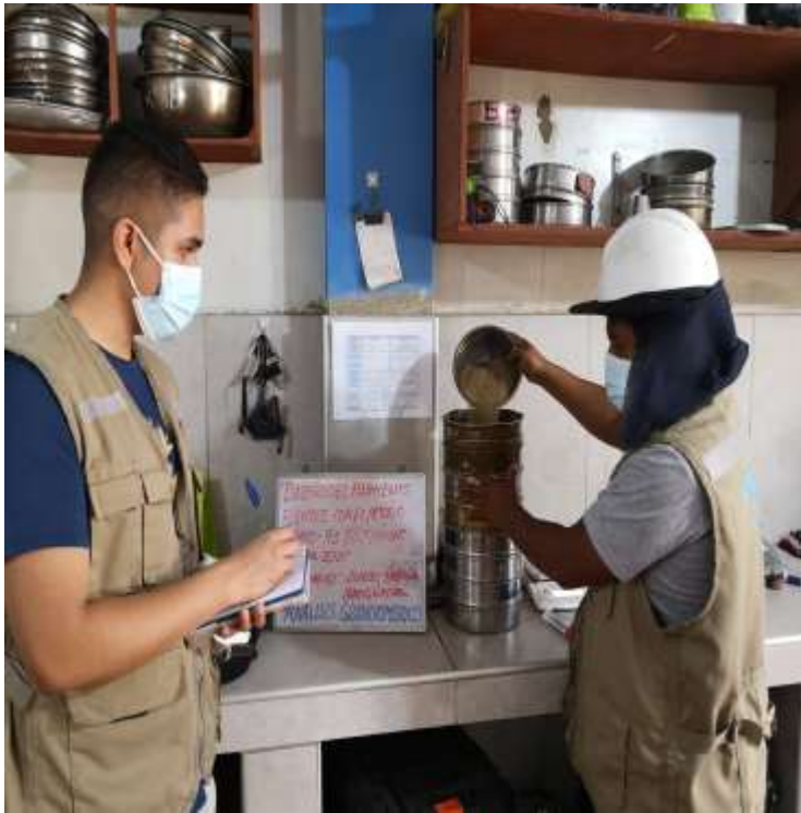
Análisis granulométrico del material extraído de cada calicata, iniciando el proceso del tamizado.
