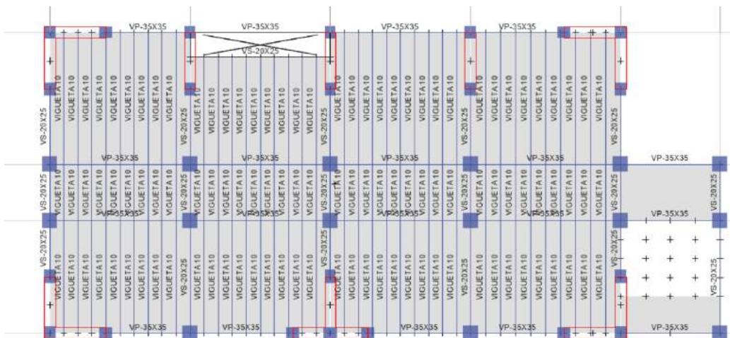
FIGURA N° 69 VIGUETAS EN LOSAS ALIGERADAS
