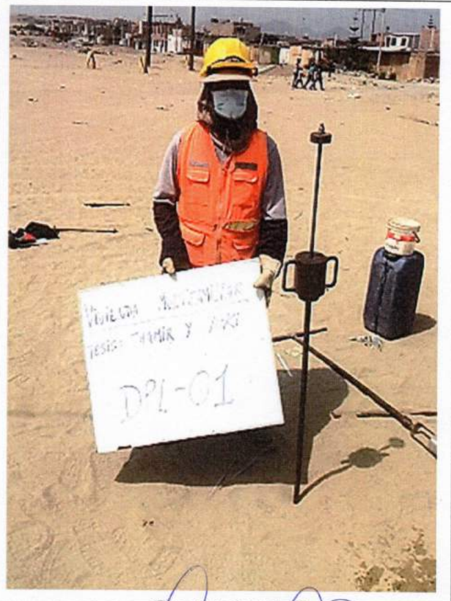
Foto N°02: Vista de la auscultación DPL-01 De 0.00m a 3.30m de profundidad, medianamente compacto a compacto.
