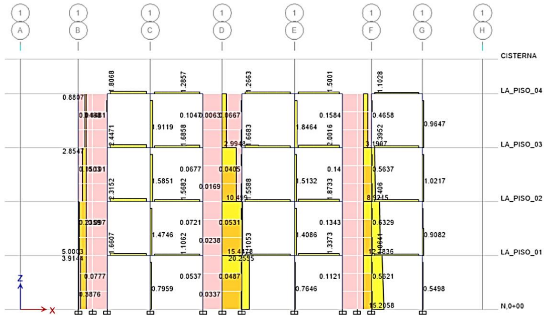
GRÁFICO N° 2 DIAGRAMA DE FUERZA CORTANTE EJE 1-1
