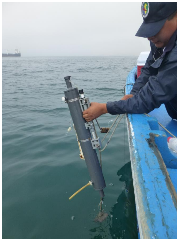
Colecta de muestras de agua del nivel subsuperficial
