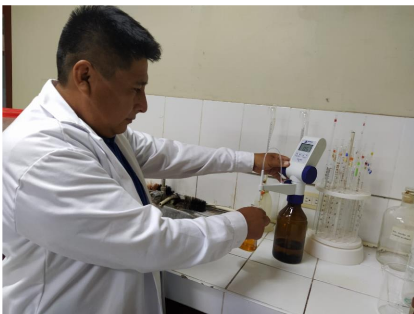
Determinación de oxígeno disuelto por el método de Winkler
