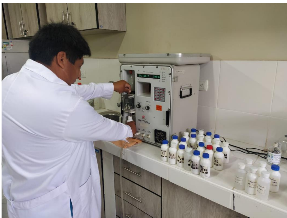
Determinación de salinidad usando el salinómetro Guildline-Portasal 8410A
