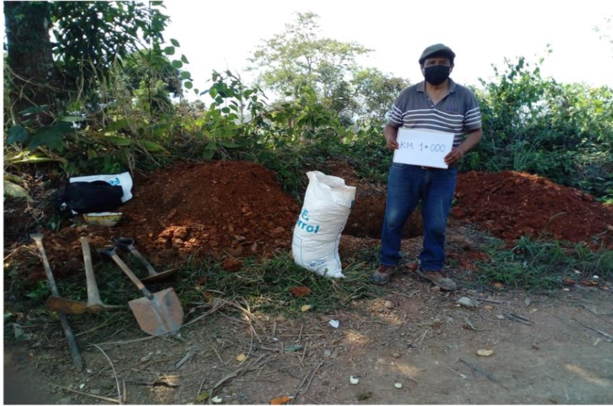
Calicata 01 (C-1) en el KM 1+000, extracción de muestra.
