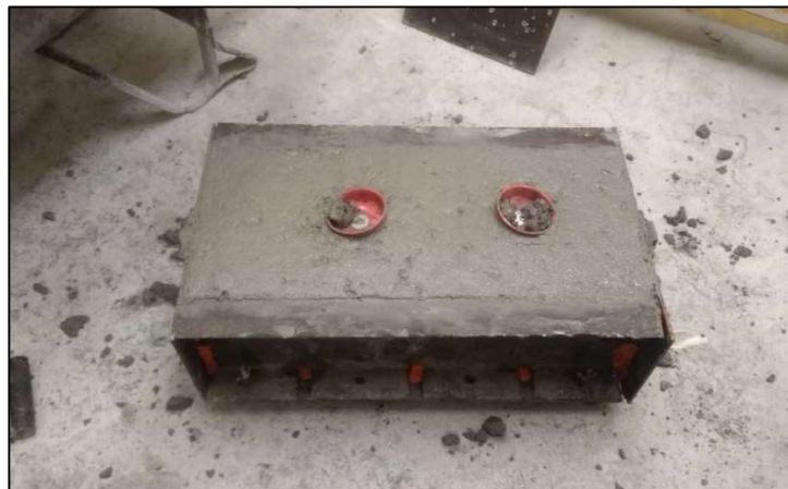
Figura 7. Probeta recién vaciada con concreto para el Pull-out test.
