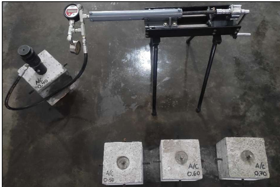
Figura 91. Equipo Pull-Out tester con el cilindro de extracción conectado en la probeta cubica.
