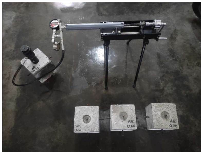
Figura 9. Sistema de extracción.
