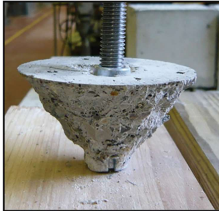
Figura 10. Trozo de concreto obtenido del ensayo de extracción Pull-Out.
