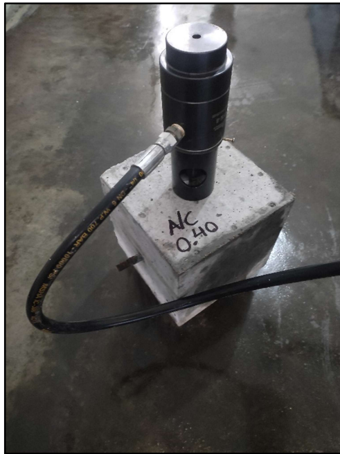
Figura 90. Equipo Pull-Out tester con el cilindro de extracción conectado a inserto embebido en probeta cubica.
