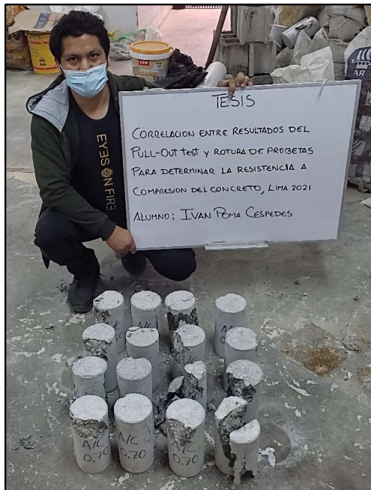
Figura 93. Probetas cilíndricas de relación a/c : 0.40, 0.50, 0.60 y 0.70 curadas 28 días y ensayadas a rotura.
